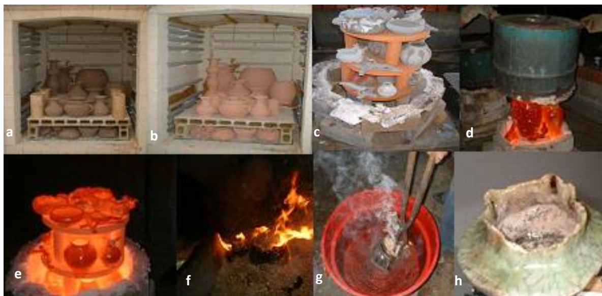
Figura 2: Proceso Raku: a) elaboración de las piezas, b) cocción para obtención del bizcocho, c) esmaltado, d) y e) cocción para fundición del esmalte f) reducción g) enfriamiento h) pieza final
