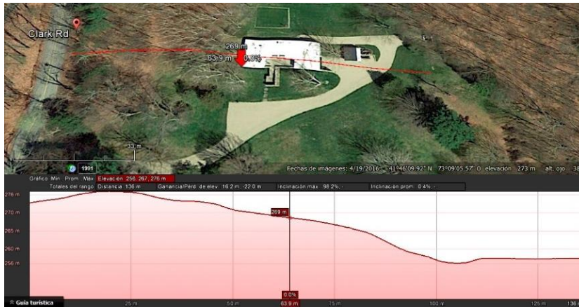
Figura 12, Corte sobre el terreno. Pendiente descendente desde el Oeste de 20m hacia el Este. Fuente Google Earth.
