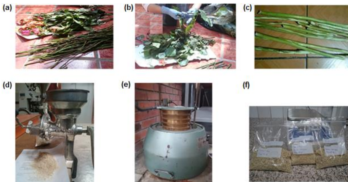
Figura 13. Preparación de la biomasa residual de tallos de rosa. (a) Selección de tallos. (b) Retiro de hojas y cortezas. (c) Secado. (d) Molido de tallos. (e) Tamizado. (f) Separación en tres tamaños de partícula.
