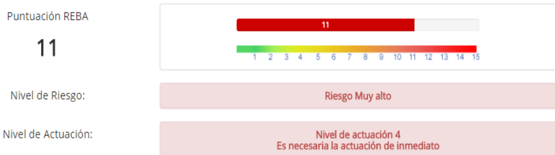
Imagen 9: Calificación final para la tarea desencofrado. Fuente: Autor
