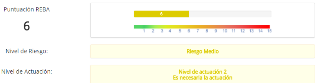
Imagen 5: Puntuación final REBA, tarea encofrado de estructuras. Fuente: Autor
