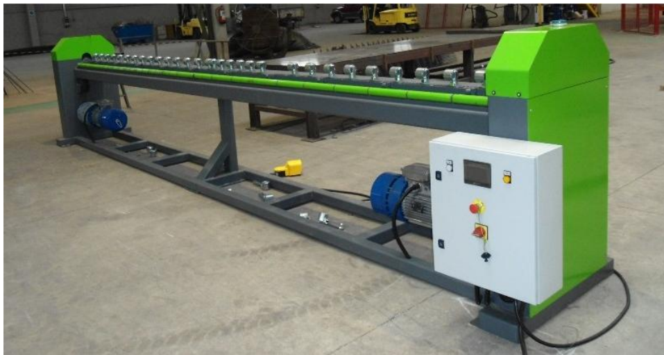
Imagen 26: Máquina dobladora y cortadora de malla.
