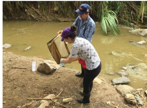
Figura 22. Los macroinvertebrados y el sustrato atrapado por la red se colocan en fundas con cierre hermético
