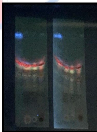
Fig 23. Cromatografías observadas en onda larga
