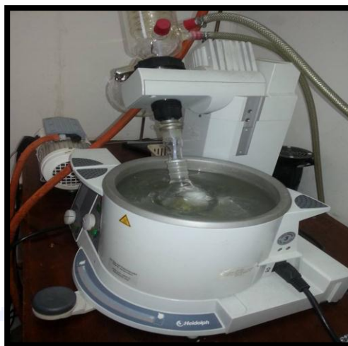
Fig. 18: Evaporación por rotavapor
