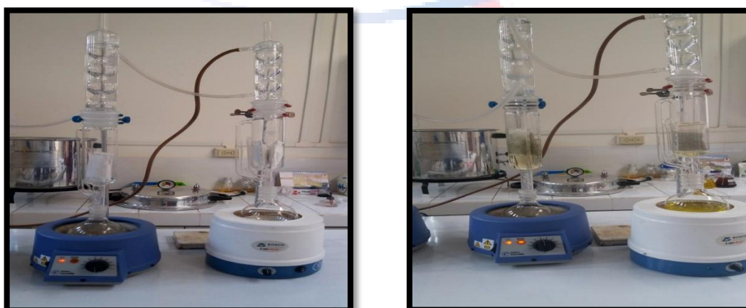
Fig.17: Extracción por Soxhlet
