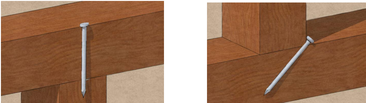
Figura 6. Uniones de elementos de madera por medio de clavos. Fuente: Pinos & Baculima, 2013.
