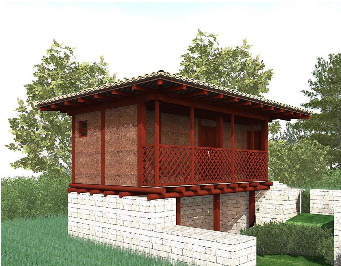
Foto 16. Vista 3D vivienda de bahareque. Autor: Paúl Rivas Rivas.
