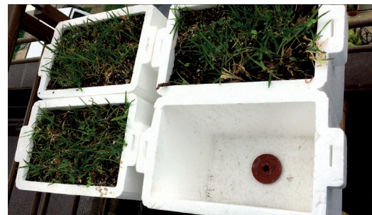
Ilustración 42. Distribución de las cuatro parcelas de ensayo, tres contienen kikuyo como elemento de remate, y uno es testigo.
