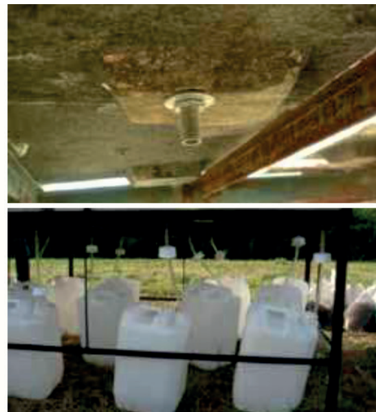
Ilustración 14. Parcelas de ensayo para simular cubiertas verdes con sistema de recolección de agua lluvia para cada parcela. (Rosatto, Héctor et al. 2010).
