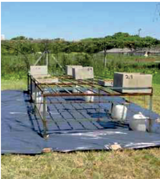
Ilustración 14. Parcelas de ensayo para simular cubiertas verdes con sistema de recolección de agua lluvia para cada parcela. (Rosatto, Héctor et al. 2010).
