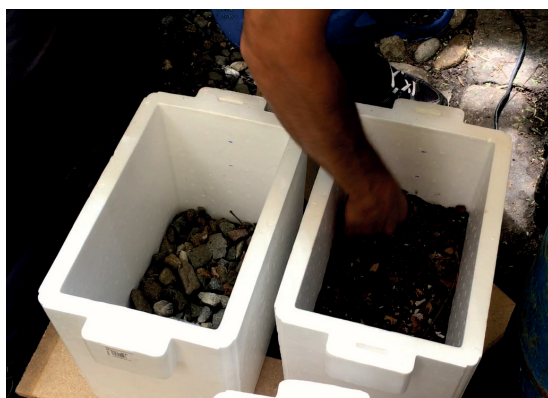
Ilustración 35. Colocación de sustrato con alivianador sobre cama de grava de diámetro promedio \frac{3}{4} (Fuente Propia).
