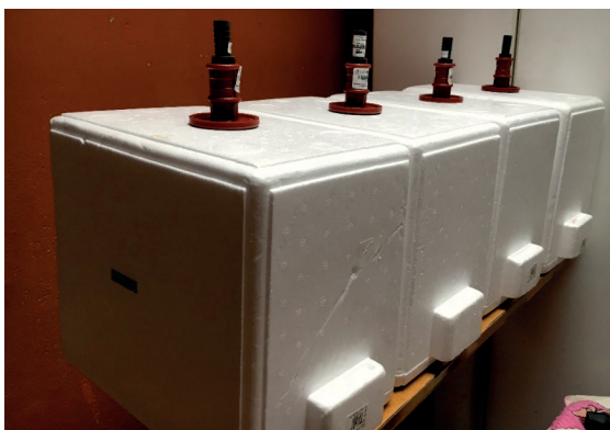
Ilustración 31. Parcelas de ensayo colocadas hacia abajo debido a los conectores de desagüe (Fuente Propia)
