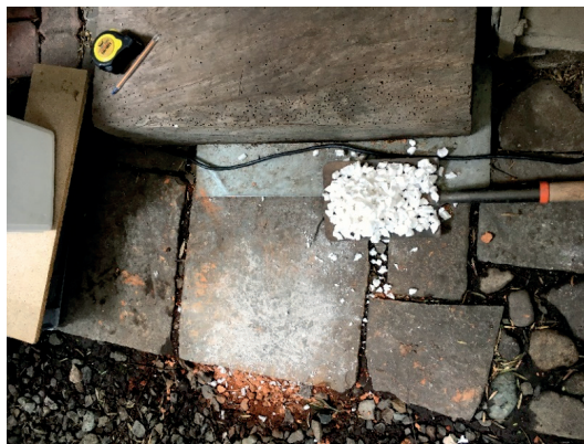
Ilustración 28. Poliestireno triturado (Fuente Propia)
