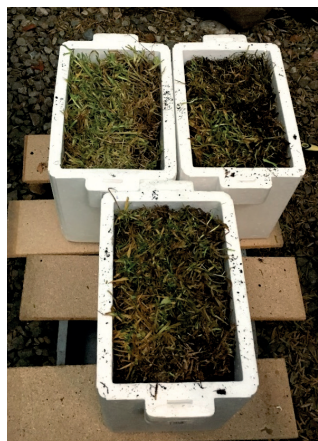
Ilustración 37. Parcelas de ensayo con sustratos diferentes y Kikuyo como especie vegetal con un alto promedio de 5cm (Fuente Propia).
