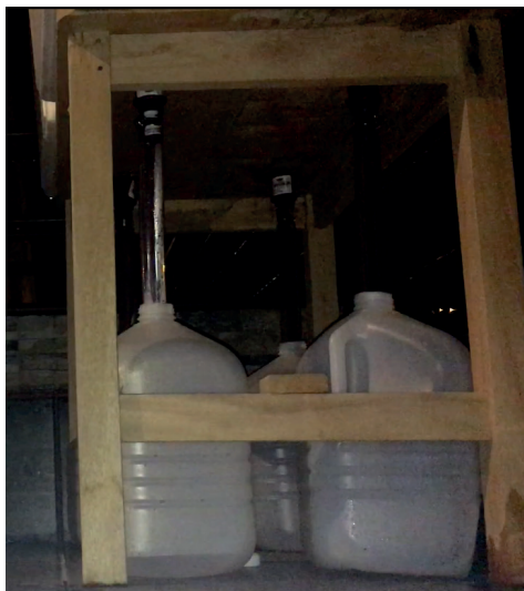
Ilustración 40. Mangueras de PVC de 1" conectadas a Bidones recolectores de 3.78lts cada uno. (Fuente Propia)
