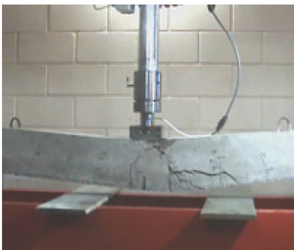
Figura 30. Rotura por flexión de una viga. (Porto, 2005)
