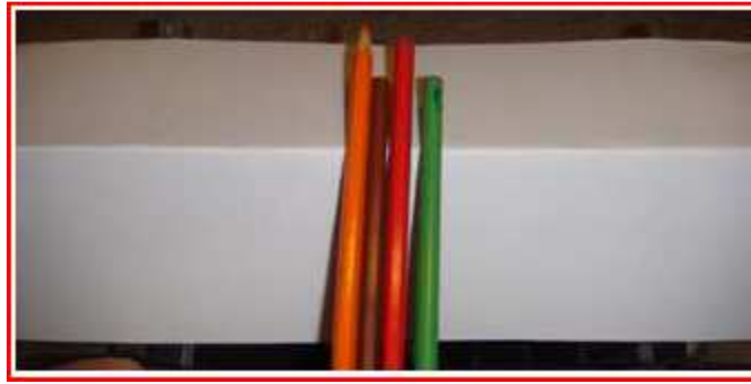
Figura 1-6. Hoja de papel plegada, simplemente apoyada con carga (4 lápices)
