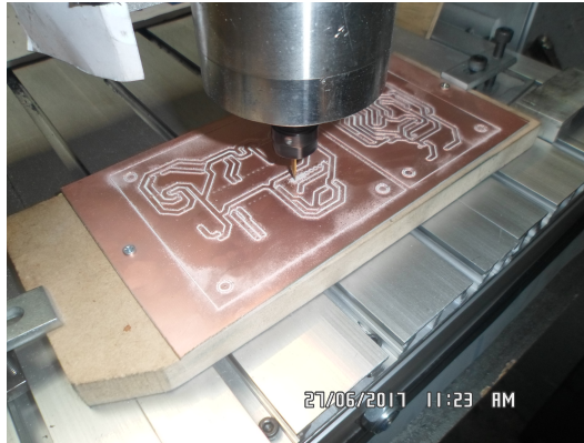
Figura 3.25: Construcción de la placa PCB con la ayuda de una máquina router CNC
