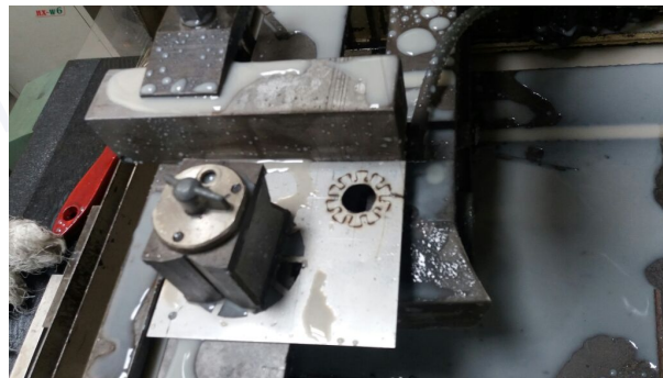
Figura 3.24: Corte del disco encoder con maquina WEDM
