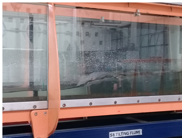
Figura 4.4: Resalto hidráulico conjuntamente con la formación de burbujas y olas
