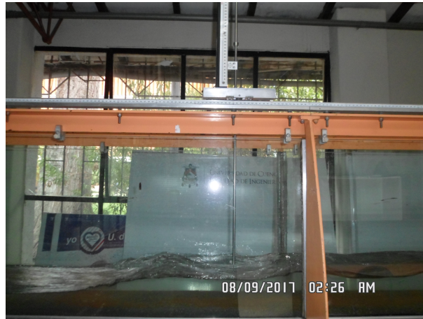
Figura 3.3: Generación del Resalto Hidráulico
