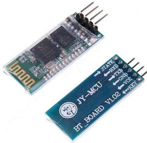
Figura 3.14: Módulo bluetooth HC-06 para la conexión inalámbrica
