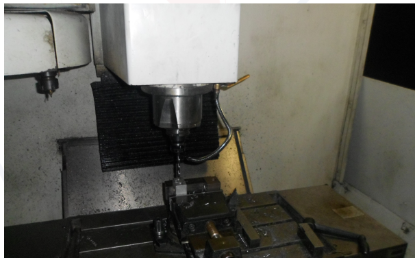
Figura 3.22: Mecanizado de los bujes-soportes
