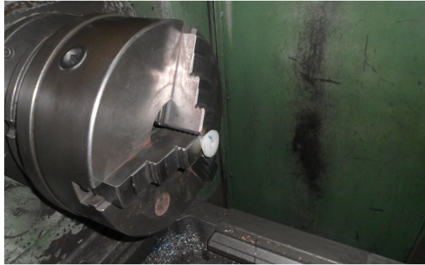
Figura 3.21: Torneado de ruedas de guiado y desplazamiento
