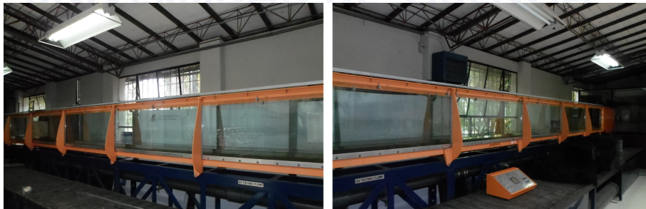
Figura 3.1: Canal hidrodinámico rectangular
