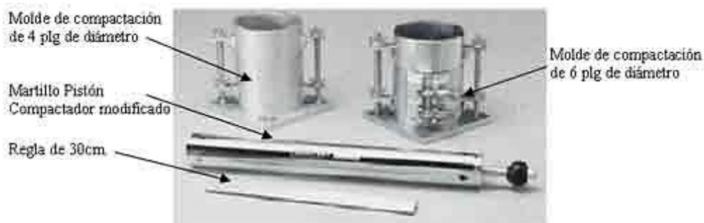
Figura 5. Equipo de compactación en laboratorio
