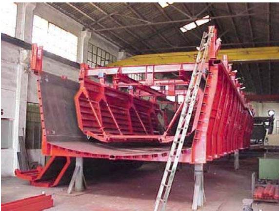
Fotos. 3.6.4.1: Encofrados metálicos para fabricación de vigas de puentes de hormigón armado
