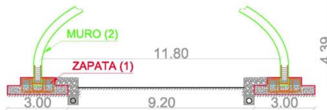
INSTALACIÓN DE MUROS Y Hº IN SITU
