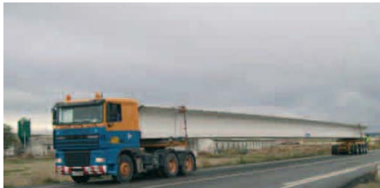
Fotos. 3.3.2: Transporte de una viga Tipo "I" Larga
