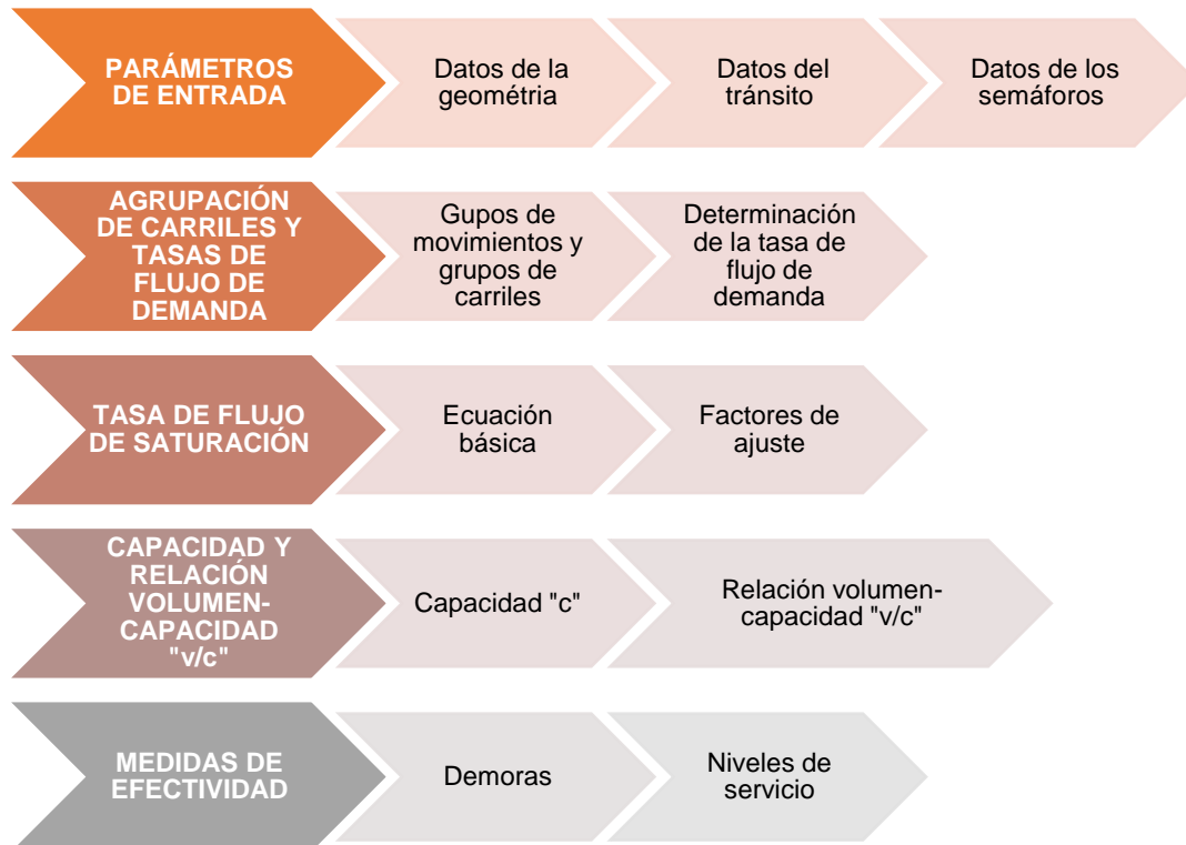
Figura 2.4. Esquema metodológico para el análisis de intersecciones con semáforos.
