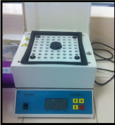
Figura 9: Baño María VORTEMP 56 EVC usado en el proceso de extracción de ADN. Fuente: Autoras
