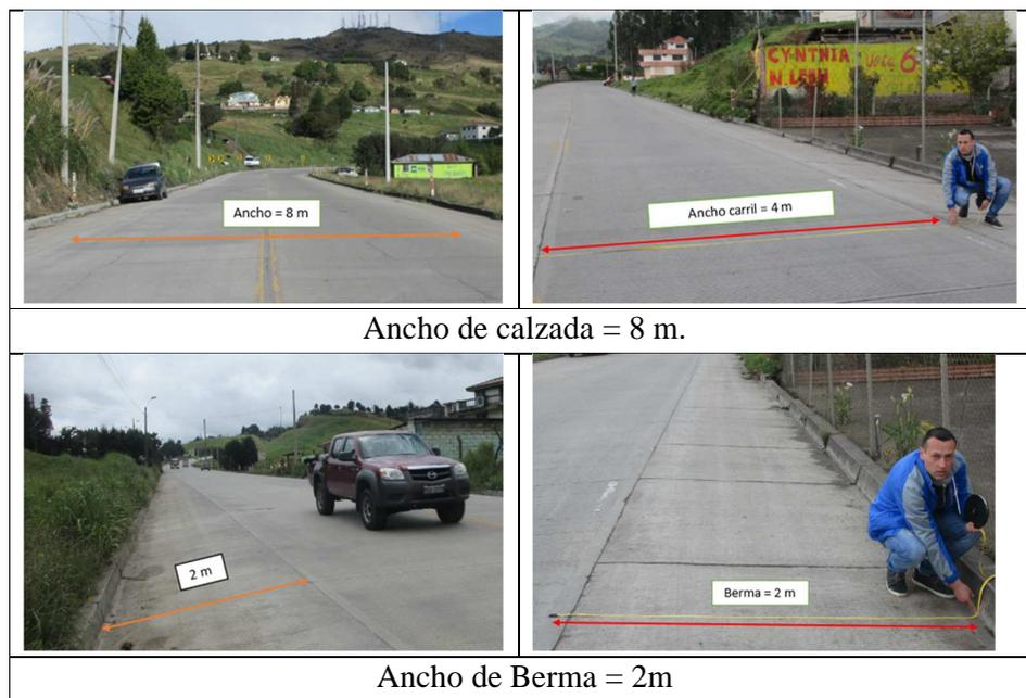
Figura 4-2. Características del segmento de prueba.
