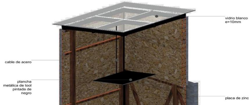
Figura 4.6 Detalle colocación de vidrio sobre estructura metálica del techo (Fuente: Propia)
