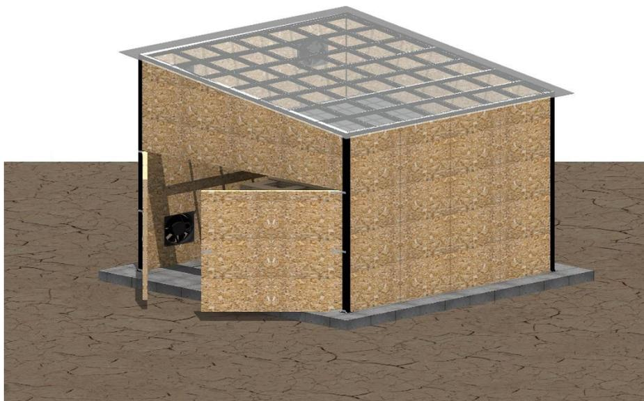
Figura 4.7 Techo de vidrio del Secador Solar (Fuente: Propia)
