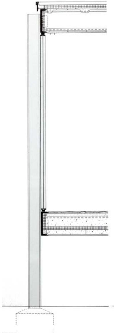
Imagen 189: Conexión estructural a nivel de piso y cubierta en la casa Farnsworth de Mies van der Rohe (1945 – 1951). Werner Blaser (1993). *Mies van der Rohe – The Art of Structure*, pág. 116, New York, USA, Whitney Library of Design.
