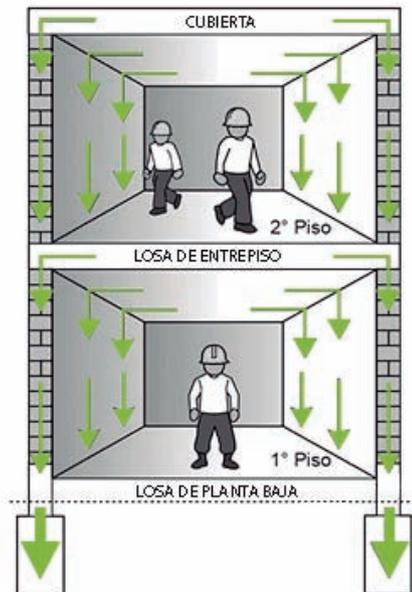
Imagen 09: Proceso de transferencia de cargas.
