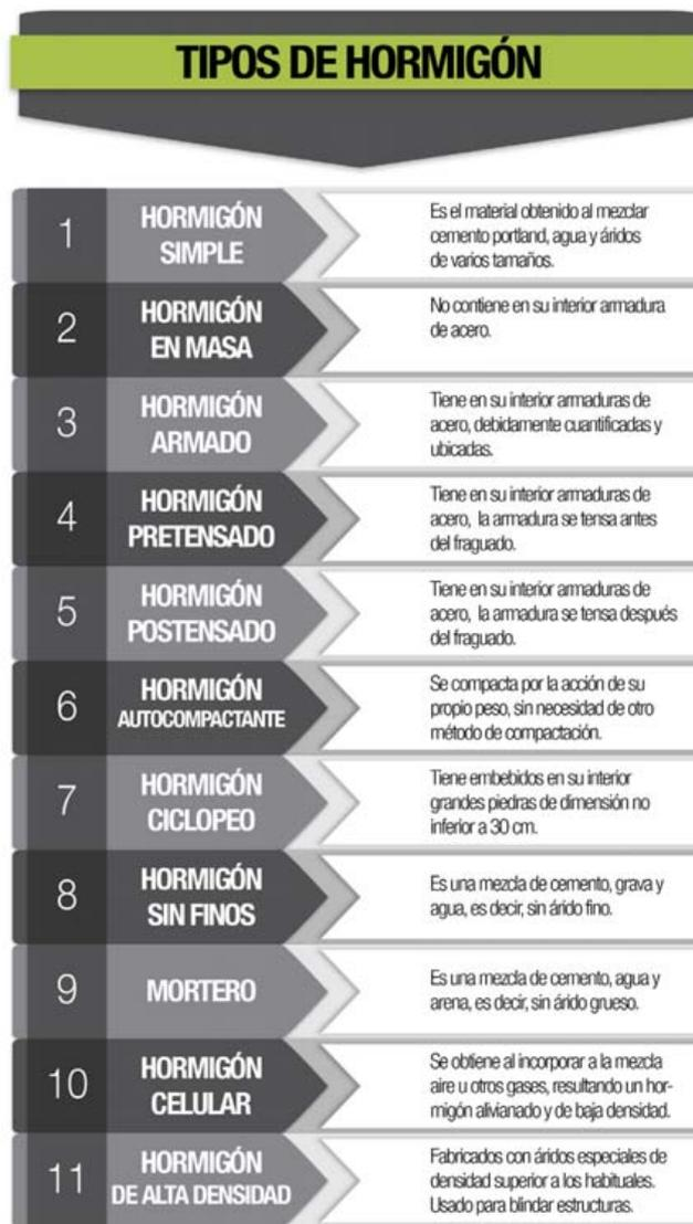
Imagen 66: Tipos de hormigón
