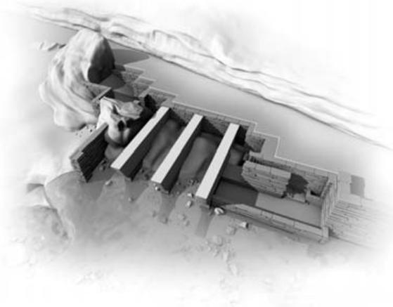
Imagen 205: Sistema cimentación y de vigas de apoyo para soporte de la primera terraza, casa de la cascada de Frank Lloyd Wright (1935 – 1939), Bear Run, Pensilvania, Estados Unidos.
