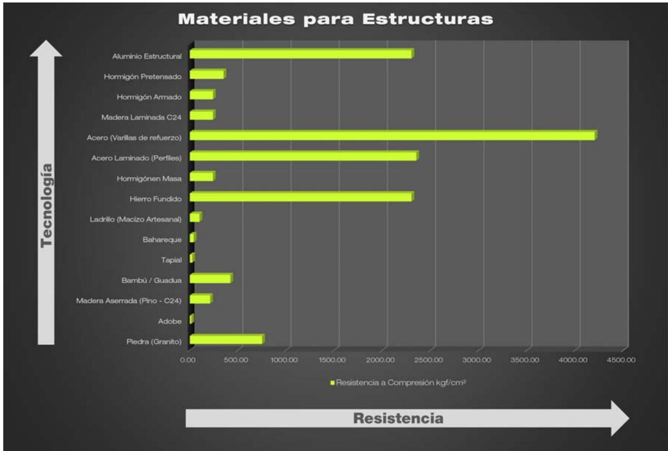
Imagen 118: Nivel tecnológico necesario para desarrollar el material y el sistema constructivo vs Resistencia a compresión.
