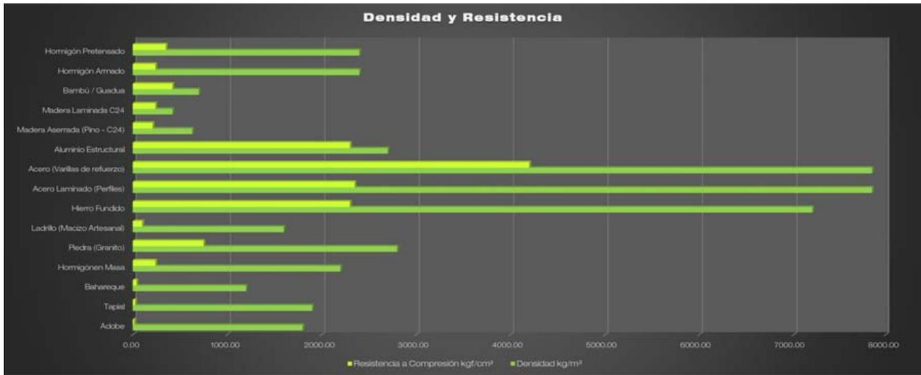
Imagen 114: Densidades y resistencias a compresión de los materiales
