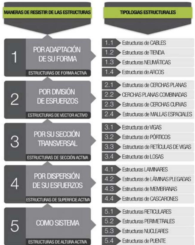
Imagen 30: Tipologías estructurales en función de la manera de resistir. Infografía de Autor
