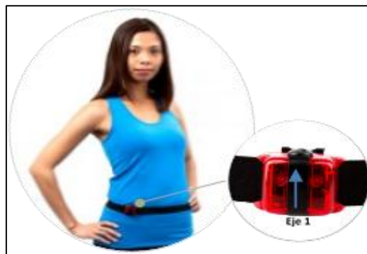
Figura 2.3. Acoplamiento del acelerómetro
