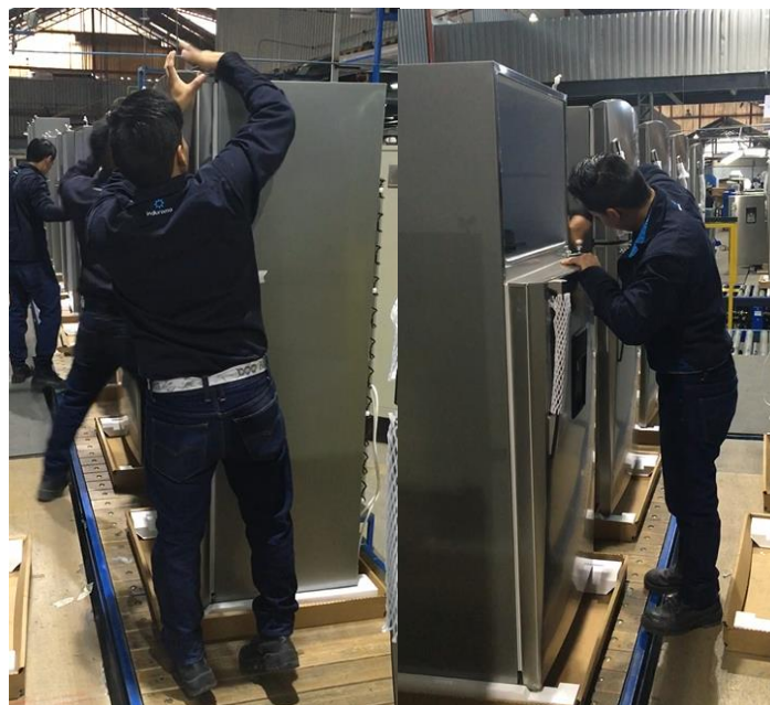
Fotografía 12: Colocación de Puertas.
