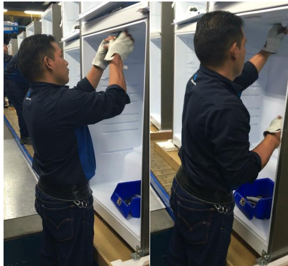
Fotografía 3: Proceso de Conexión e Instalación del Control de Temperatura.
