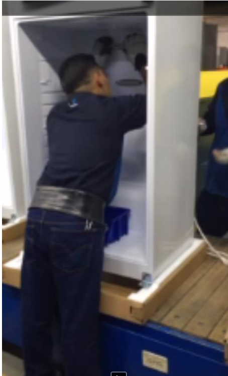
Fotografía 11. Conexión y Colocación de Control de Temperatura. Fuente: Autora
