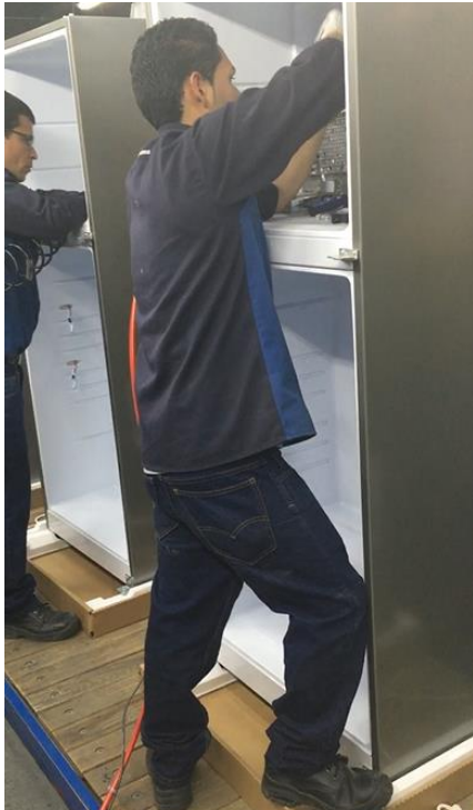
Fotografía 10: Colocación de Evaporador y Anillado.
