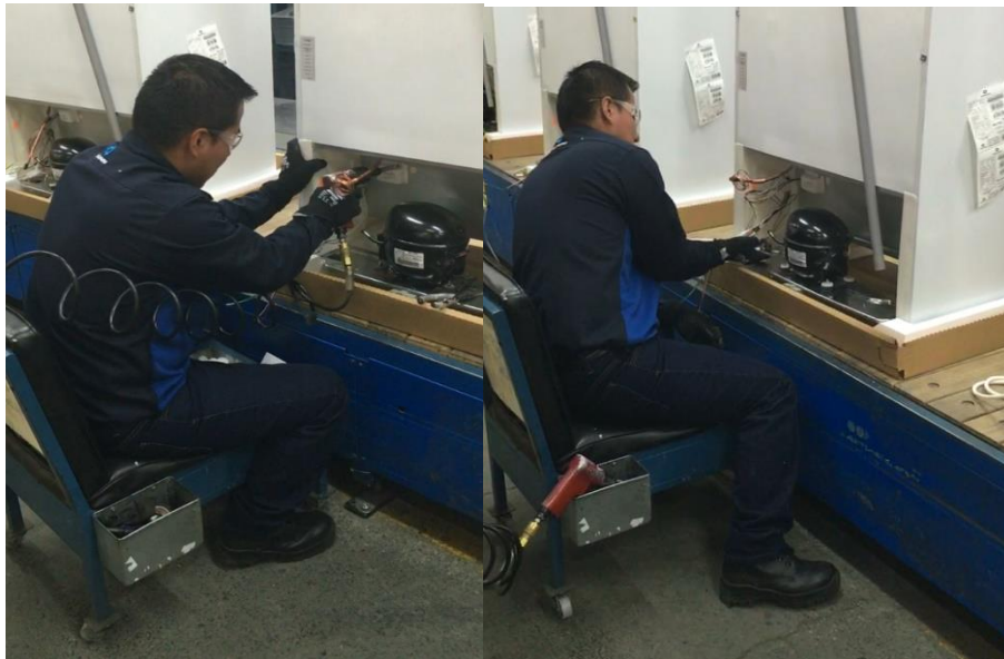
Fotografía 4: Proceso de Instalación de Timer, Compresor y Embalaje Especial.
