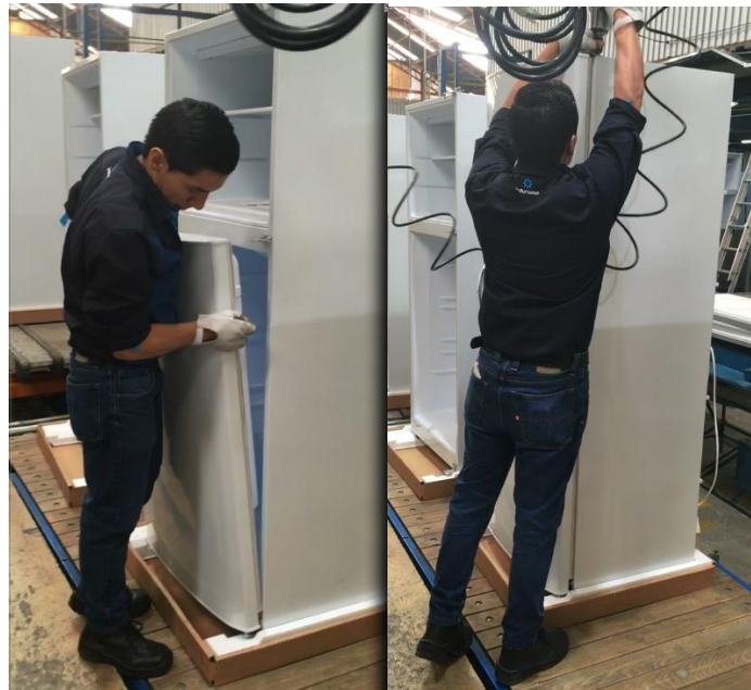
Fotografía 5: Proceso de Colocación de Puertas.
