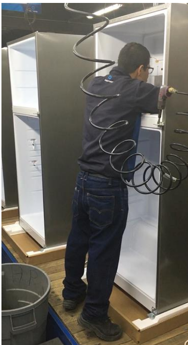
Fotografía 9: Colocación de evaporador y anillado. Fuente: Autora
