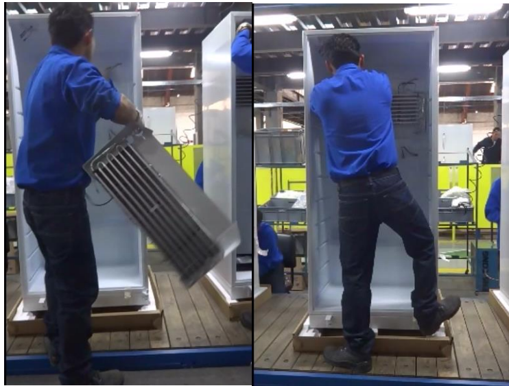
Fotografía 2: Proceso de Colocación de Evaporador y Anillado.
