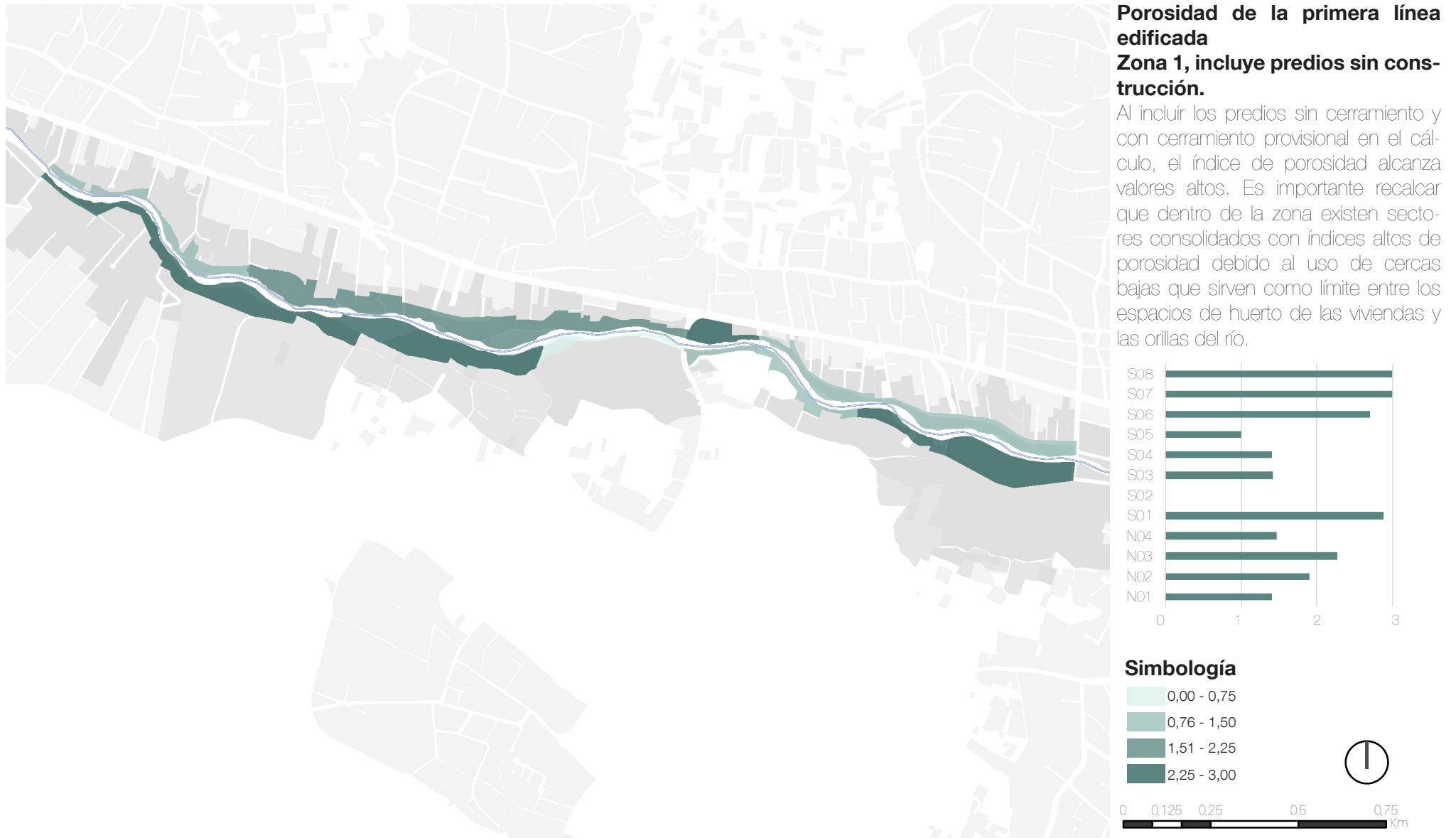
Figura 2.170 Zona 1, incluye predios sin construcción.
