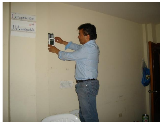
Fotografía 52: Instalación de registrador de datos en el interior de la vivienda.
