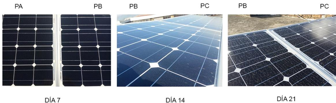
*Fig. 21: Paneles monocristalinos con acumulación de suciedad durante 21 días
