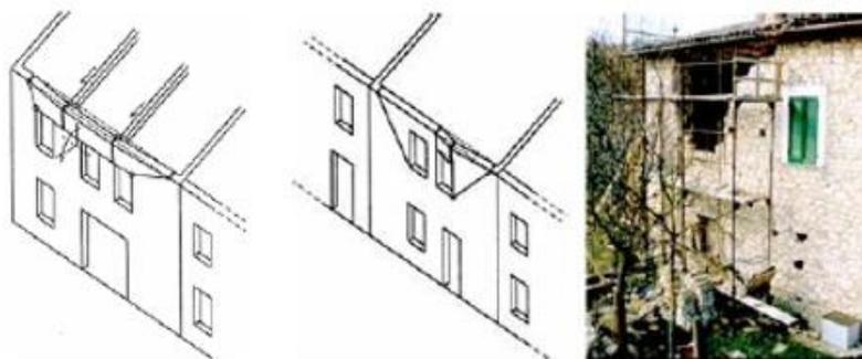
Figura 3.13. Volcamiento parcial de pared de MNR por efecto de arco.
