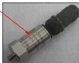
Figura 6.53: Detalle del sensor de vibración.
