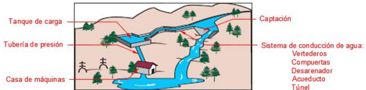
Figura 2.3: Central hidroeléctrica de embalse.
