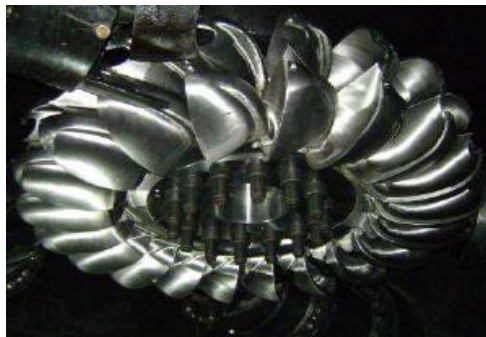
Figura 2.5: Turbina Pelton de la central Ocaña
