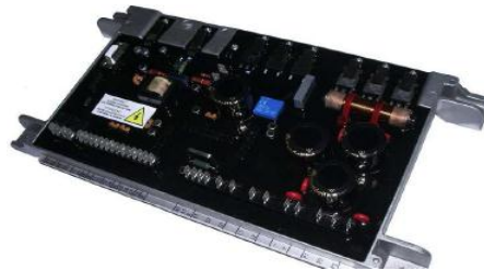
Figura 6.48: Tarjeta electrónica del regulador automático de tensión.
