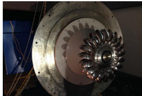
Figura 4.11: Rodete antes de su montaje en la casa de máquinas.
