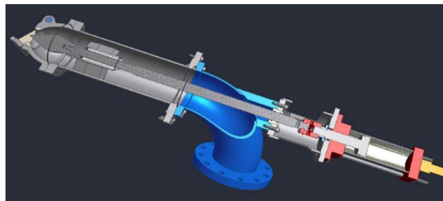
Figura 4.13: Esquema de un inyector.
