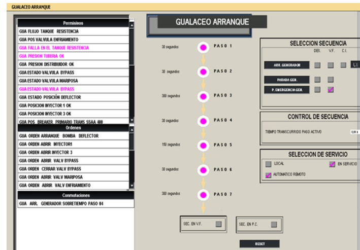
Figura 5.6: Pantalla de visualización del arranque de la mini central.
