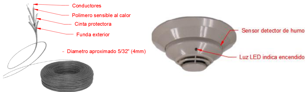
Figura 6.101: Detalle de detector lineal de calor y sensor de humo.
