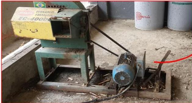
Cargas Especiales que pueden derivar en cortocircuitos, ya que se encuentra conectadas a la intemperie
