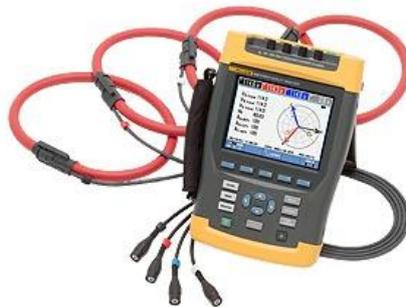
**Figura 3.5:** Analizador de Red Fluke (435).
