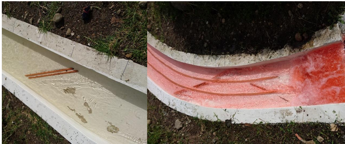
Figura. 37 Líneas de corriente en rápida 1, resalto hidráulico en rápida dos, funcionamiento no adecuado del cuenco disipador
