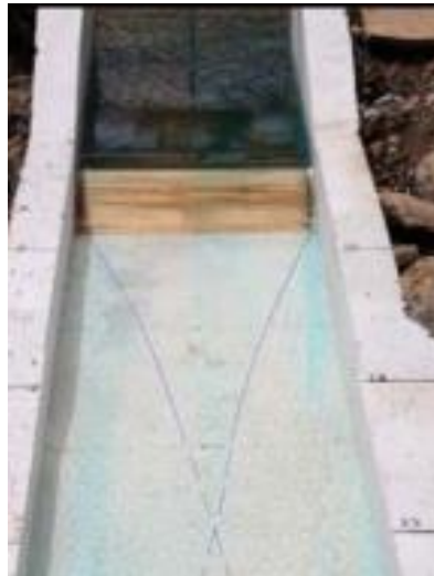
Figura. 144. Visualización de líneas de flujo oblicuas en laboratorio. Diseño Original
