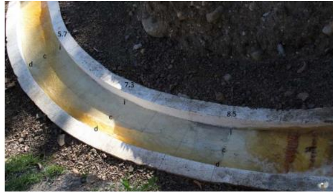
Figura. 5. secciones transversales y dirección del flujo en la rápida en curva. Diseño Original
