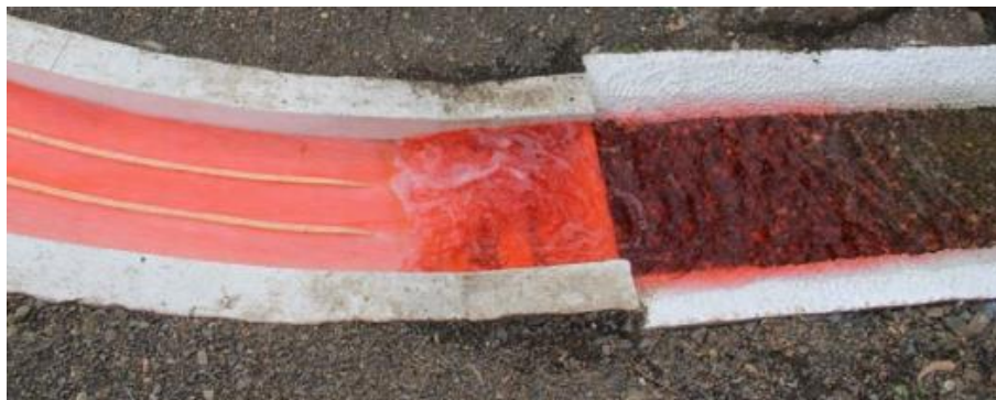
Figura. 32 Óptimo funcionamiento del cuenco disipador, no se presenta socavación en canal de restitución. Q=13.72 m 3 /s Alternativa 3-5
