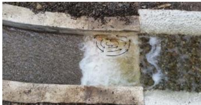
Figura. 27 Vórtice formado en el cuenco dissipador debido a caudal máximo de diseño, 30.95 m 3 /s, Alternativa 3-4
