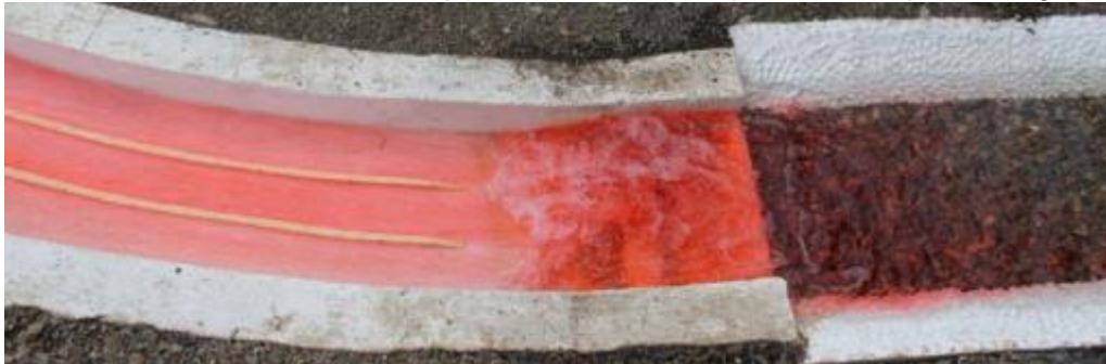
Figura. 33 Comportamiento adecuado del flujo en cuenco dissipador, canal de restitución sin socavación. Q (100 años) =14.94 m 3 /s Alternativa 3-5
