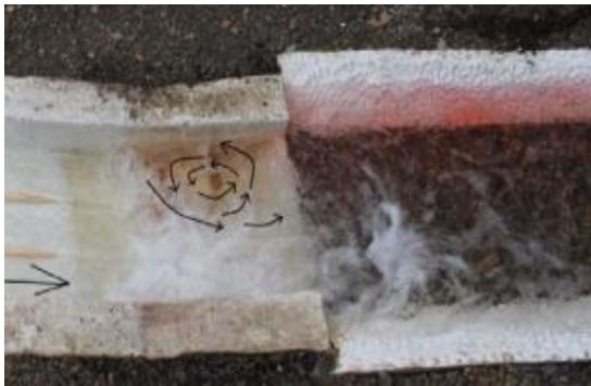
Figura. 34 Comportamiento de flujo para Qmax de diseño Alternativa 3-5
