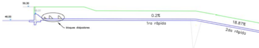
Figura. 10 Datos disipadores de energía al pie del Creager. Alternativa 2-2
