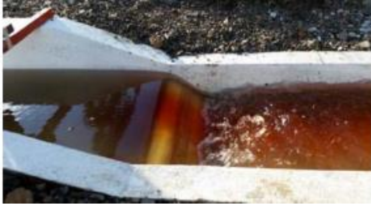
Figura. 16. Resalto Hidráulico al pie del Creager. Alternativa 2-6
