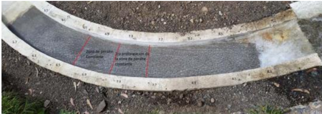
Figura. 23 Implementación de la prolongación del peralte. Alternativa 3-3
