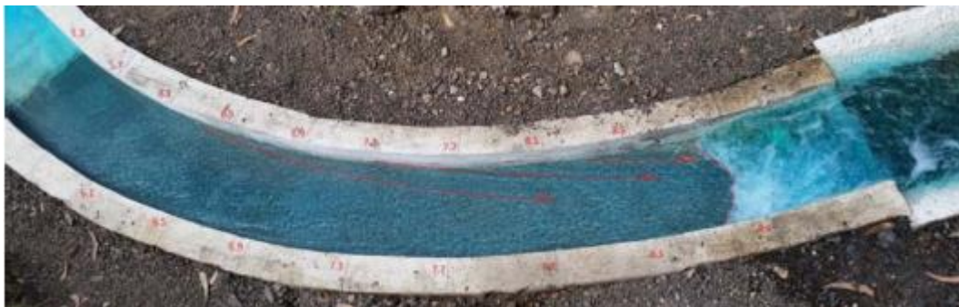
Figura. 24. Patrones de flujo predominantes en la rápida 2. Alternativa 3-3
