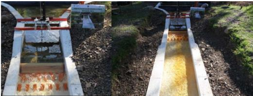
Figura. 11. Resalto sumergido. Alternativa 2-2
