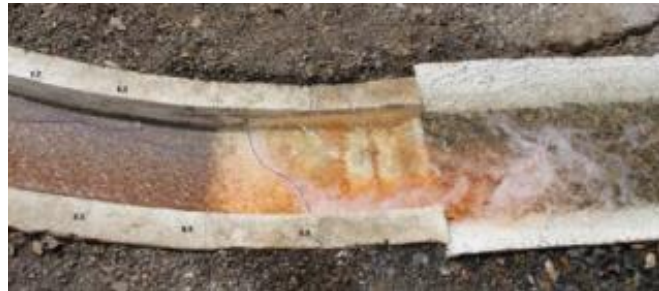
Figura. 19. Funcionamiento ineficiente del cuenco disipador. Alternativa 3-1
