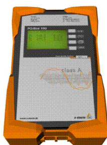
Figura 2. 18 Analizador de calidad de energía PQ-Box 100 [21]
