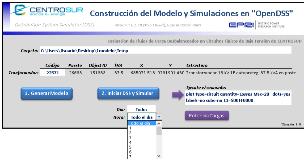
Figura 3. 12 Interfaz para la creación del modelo de red y simulación con perfiles
