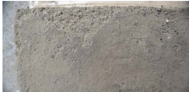
Imagen 217. Muestra con disco abrasivo #1500. Delgado K. y Flores C. (2017).
