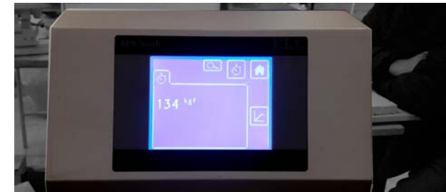
Imagen 117. Resultado de máxima resistencia a la flexión de piezas de arcilla por Flores, C. 2017.
