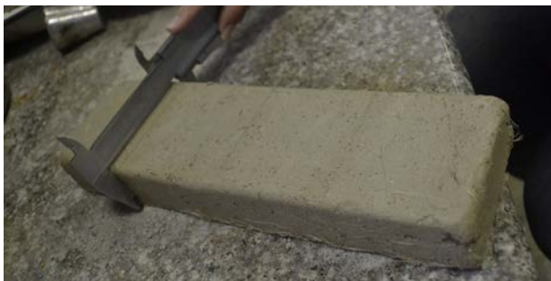
Imagen 196. Proceso de medición de retracción de las muestras. Delgado, K. y Flores C. (2017).
