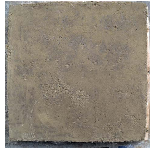
Imagen 223. Muestra con disco abrasivo #3000. Delgado K. y Flores C. (2017).
