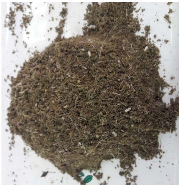
Imagen 194. Muestra con arcilla, arena y cabuya. Delgado, K. y Flores, C. (2017).
