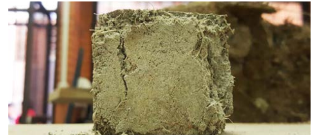
Imagen 175. Cubo realizado de tierra con cemento después de la resistencia a la compresión por Delgado, K. y Flores, C. (2017).
