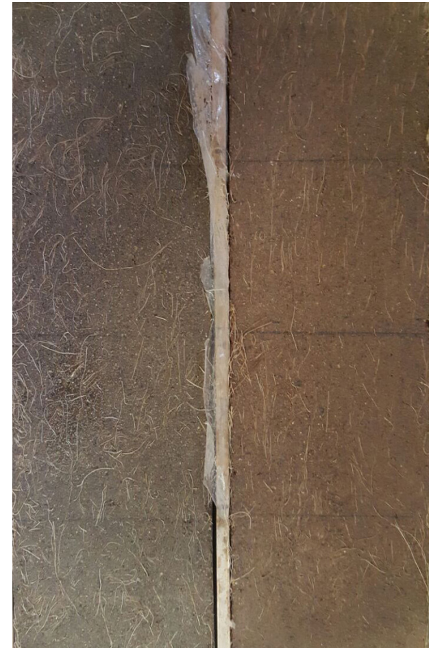
Imagen 197. Muestras finales para retracción, solamente con cabuya (izquierda) y residuos cerámicos (derecha). Delgado, K. y Flores C. (2017).
