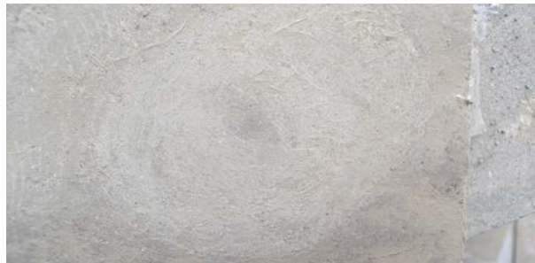
Imagen 221. Muestra con disco abrasivo #800. Delgado K. y Flores C. (2017).
