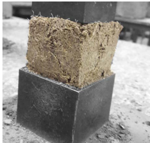
Imagen 186. Muestra de piso con aserrín ensayada a compresión. Delgado, K. y Flores, C. (2017).
