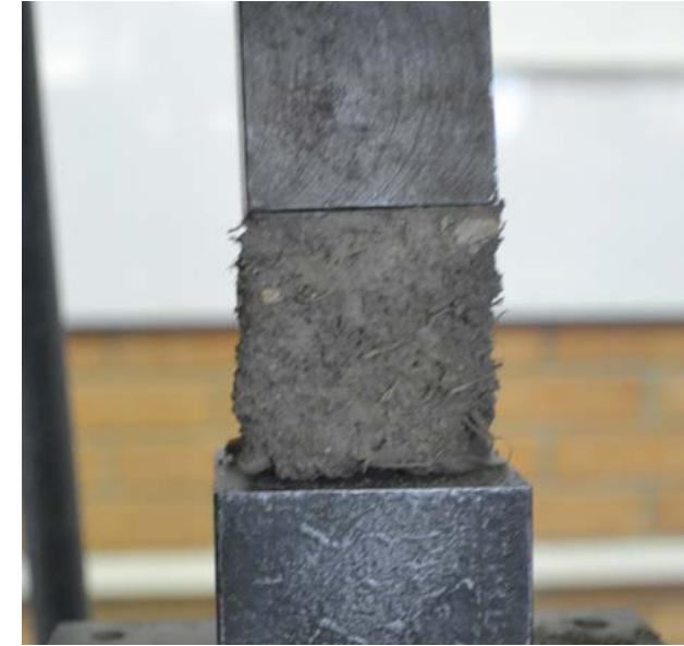
Imagen 134. Ensayo a compresión de las piezas por Flores, C. 2017.
