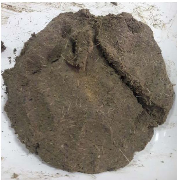
Imagen 193. Muestra con porcentaje de residuos cerámicos. Delgado, K. y Flores, C. (2017).
