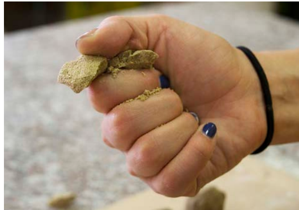
Imagen 149. Ensayo de las bolitas de presencia de arcilla por Flores, C. 2017.
