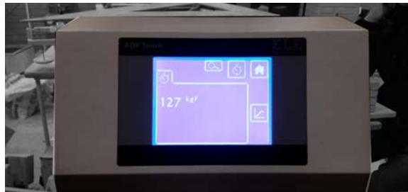
Imagen 114. Resultado de máxima resistencia a la flexión de ladrillo por Flores, C. 2017.
