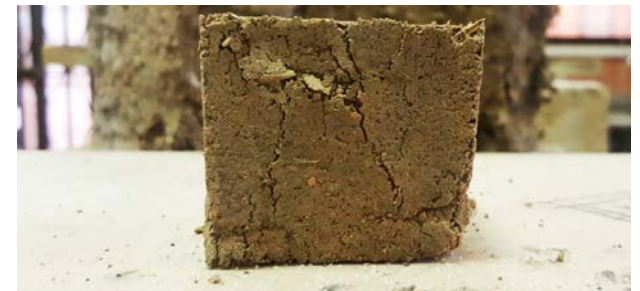
Imagen 177. Cubo realizado de tierra con residuos de ladrillo después de la prueba de resistencia a compresión por Delgado, K. y Flores, C. (2017).
