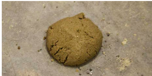
Imagen 155. Prueba de humedad estrato limoso por Flores, C. 2017.
