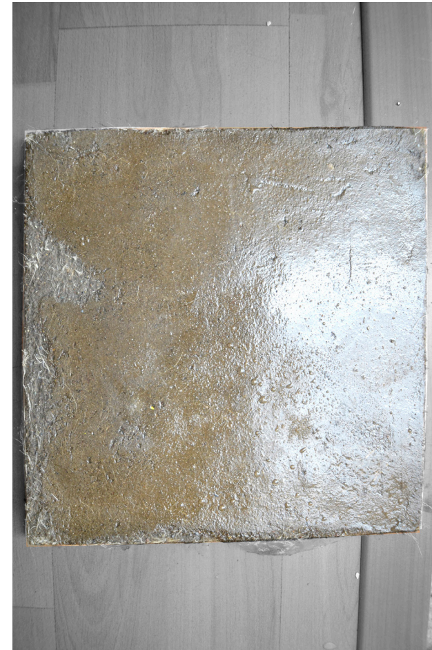
Imagen 209. Muestra con cola de guagra. Delgado K. y Flores C. (2017).
