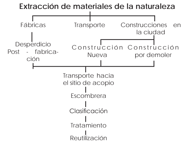
Esquema 02. Proceso de extracción de materiales de construcción. Recuperado de: M.V. & Saldaña Peralta, P.G. 2015.
