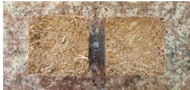
Imagen 178. Cubo realizado con cabuya, aquí se observa la excesiva cantidad de arena. Delgado, K. y Flores, C. (2017).
