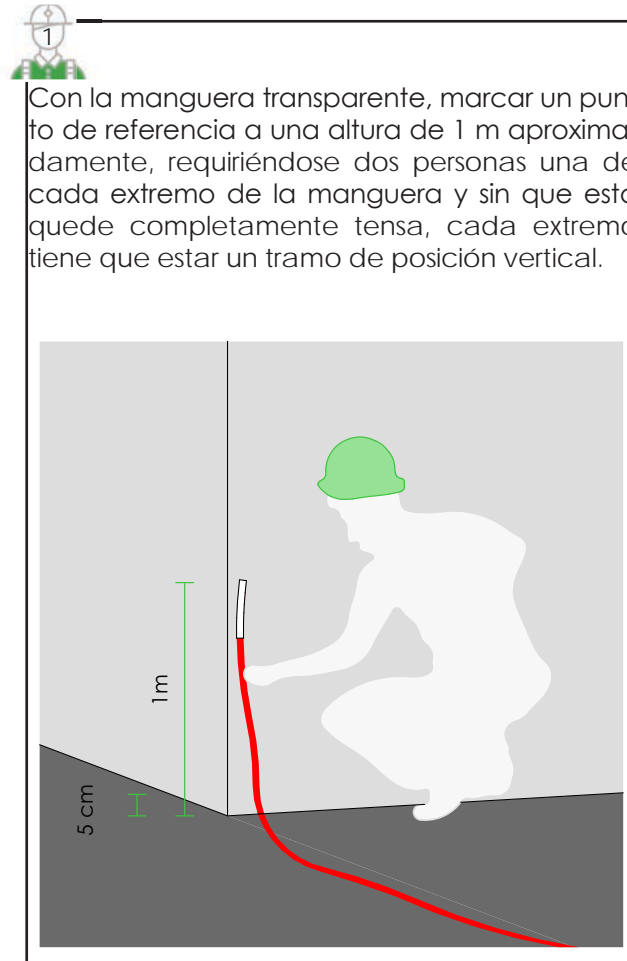
Gráfico 34. Puntos de referencia para nivelación. Flores, C. (2017).
