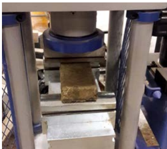
Imagen 112. Máquina de ensayo de resistencia a la flexión de piezas por Flores, C. 2017.
