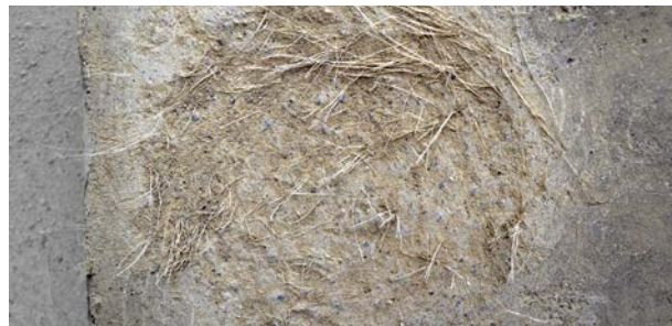
Imagen 219. Muestra con disco abrasivo #500. Delgado K. y Flores C. (2017).
