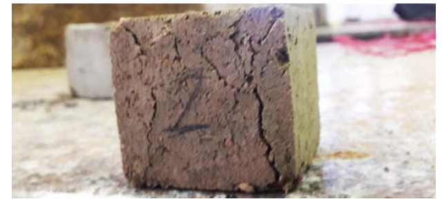
Imagen 176. Cubo realizado de tierra con cascarilla de arroz después de la prueba de resistencia a compresión por Delgado, K. y Flores, C. (2017).
