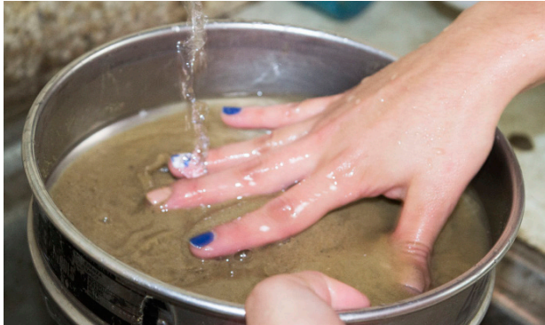
Imagen 163. Ensayo de granulometría de finos por Flores, C. 2017.
