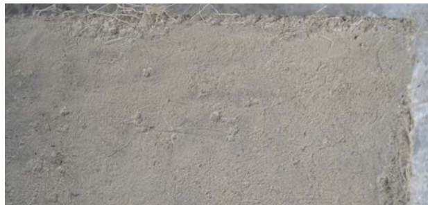
Imagen 216. Muestra con disco abrasivo #2000. Delgado K. y Flores C. (2017).
