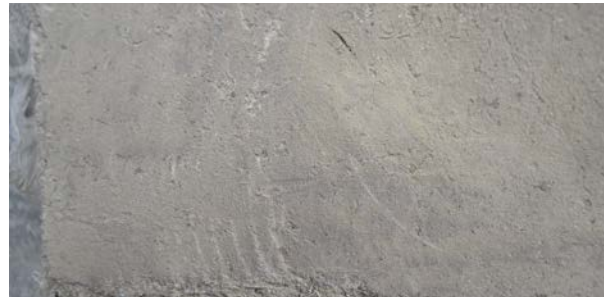
Imagen 220. Muestra con disco abrasivo #1500. Delgado K. y Flores C. (2017).
