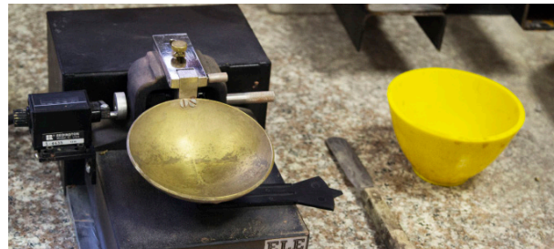
Imagen 161. Casa grande para ensayo de límite líquido, por Flores, C. 2017.
