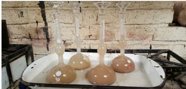
Imagen 170. Prueba de densidad de materiales, por Delgado, K.
