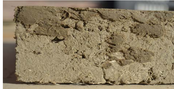
Imagen 202. Capa de nivelación de pisos. Delgado, K. y Flores, C. (2017).
