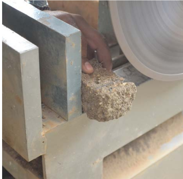
Imagen 133. Piezas de arcilla cortadas de ensayo por Flores, C. 2017.
