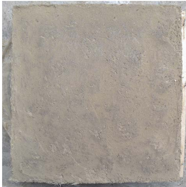
Imagen 215. Muestra con disco abrasivo #3000. Delgado K. y Flores C. (2017).
