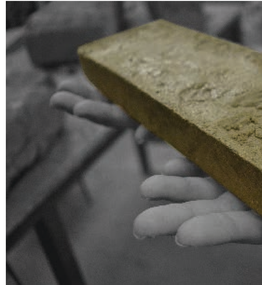
Imagen 105. Prototipo a escala para medir la retracción de la arcilla por Cristian, F. 2017.
