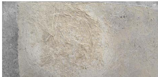
Imagen 218. Muestra con disco abrasivo #800. Delgado K. y Flores C. (2017).
