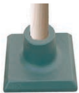
Imagen 24. Pisón utilizado en el estudio de caso 01. Recuperado de: Sols intérieurs en terre crue por Lemarquis, A. (2014).
