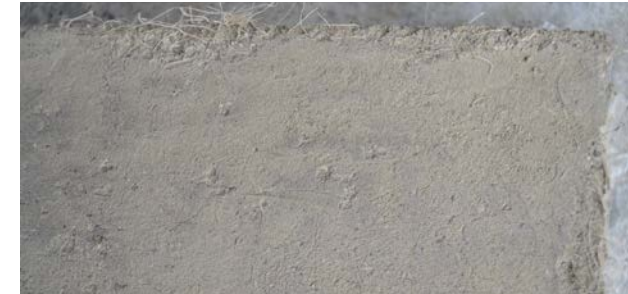
Imagen 224. Muestra con disco abrasivo #2000. Delgado K. y Flores C. (2017).
