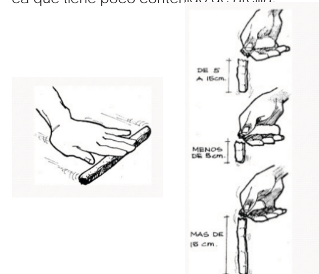
Imagen 74. Prueba de cinta de barro. Recuperado de: https://es.slideshare.net/Rubens1009/01-adobe-y-tapial .
