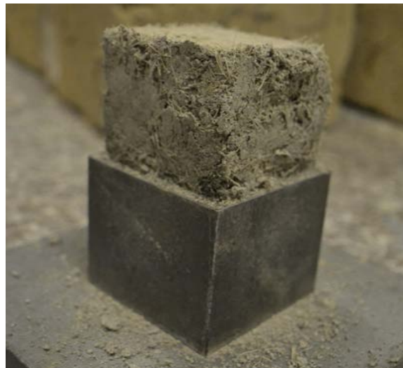
Imagen 181. Cubos de ensayo a compresión relación al 57%. Delgado, K. y Flores, C. (2017).
