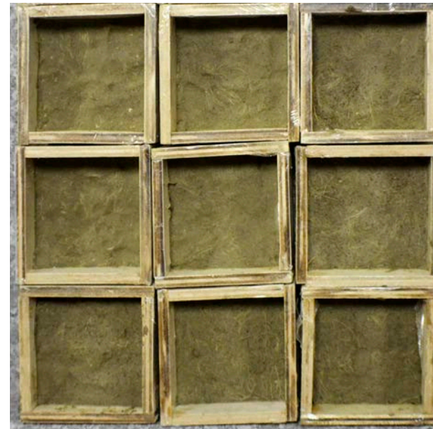
Imagen 203. Muestras de 10 x 10 x 5 cm para resistencia al agua. Delgado, K. y Flores, C. (2017).
