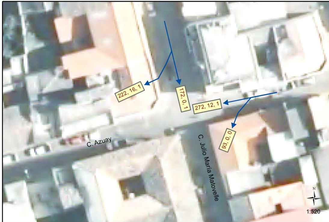
FIGURA 2-17.- FLUJOS VEHICULAR EN HORA PICO DE LA INTERSECCIÓN AZUAY Y JULIO MARÍA MATOVELLE.
