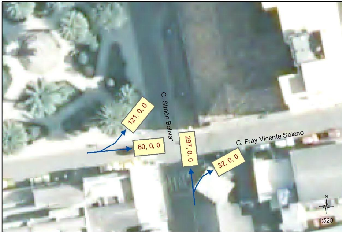
FIGURA 2-11.- FLUJOS VEHICULAR EN HORA PICO DE LA INTERSECCIÓN FRAY VICENTE SOLANO Y SIMÓN BOLÍVAR.
