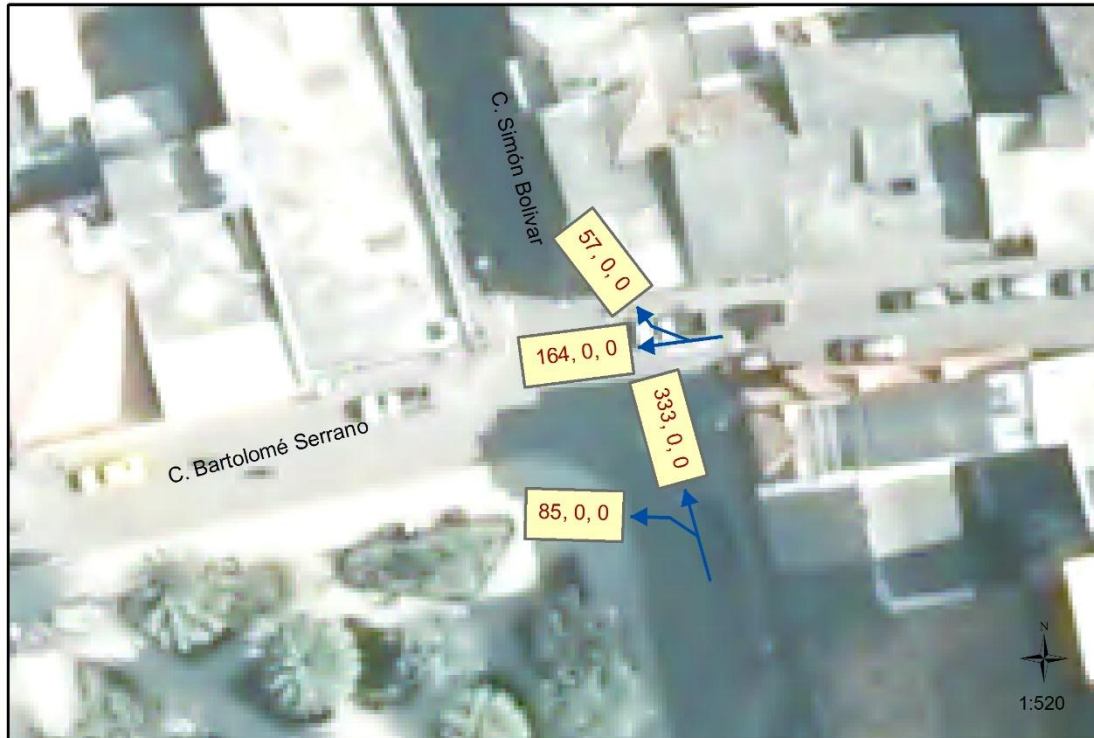
FIGURA 2-10.- FLUJOS VEHICULAR EN HORA PICO DE LA INTERSECCIÓN BARTOLOMÉ SERRANO Y SIMÓN BOLÍVAR.
