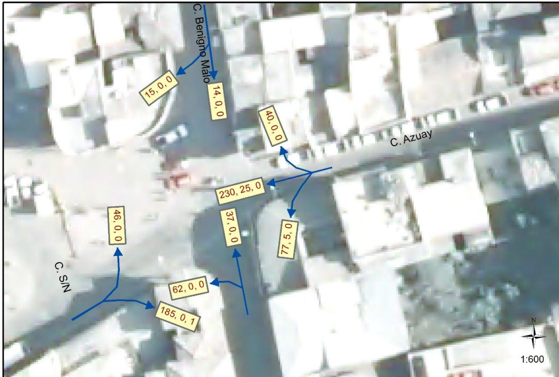
FIGURA 2-19.- FLUJOS VEHICULAR EN HORA PICO DE LA INTERSECCIÓN AZUAY Y BENIGNO MALO.
