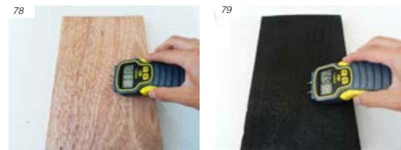
FOTO 78 y 79: Medición de humedad antes y después de la quema Fuente: Autores
