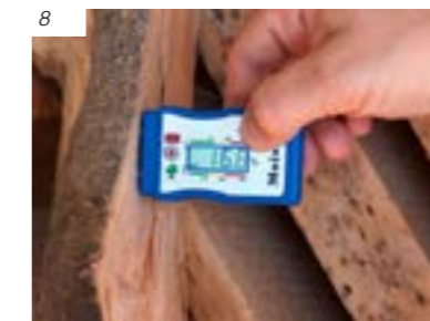
FOTO 7: El efecto higroscópico de la madera produce cambios de volumen en la muestra. Fuente: http://victoriavivancos.blogspot.com/2011/11/la-higroscopicidad-de-la-madera.html
