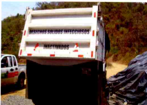
Fig. 5 Volquete de 10 m3 de capacidad, empleado para el transporte de desechos inactivados hacia el Relleno Sanitario de Pichacay
