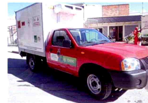
Fig. 2 Camioneta de 4 m 3 para la recolección de desechos infecciosos
