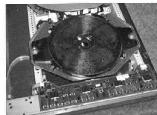
Fig. 2. Bobina real empleada en una cocina por inducción magnética.
