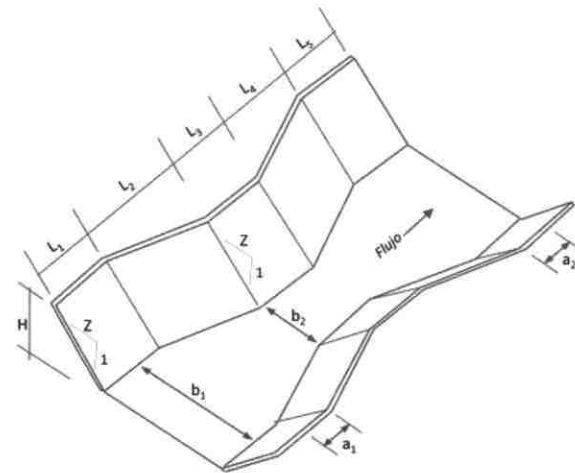
Figura 1. Configuración geométrica general del aforador Standard S359.1 Fuente: American Society of Agricultural Engineers, 1982-1983
