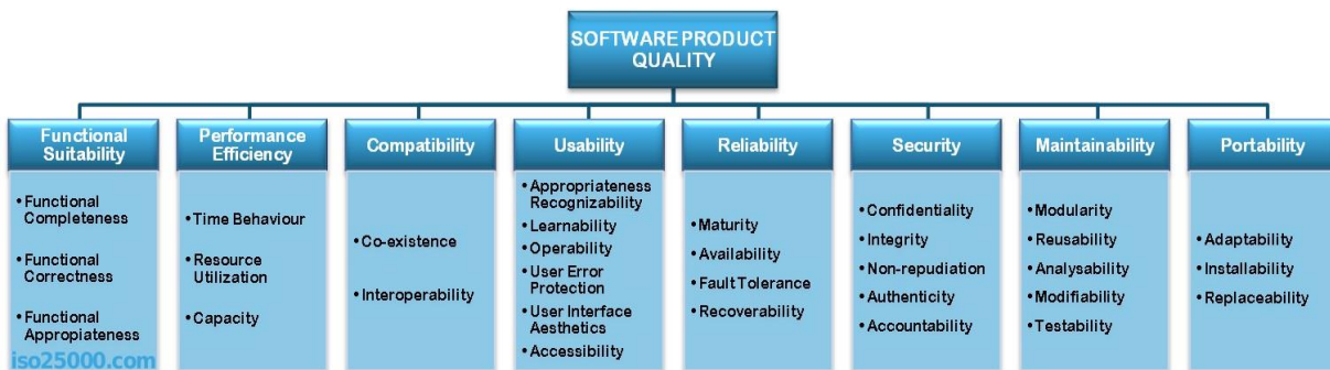
Ilustración 3. Características de la ISO/IEC 25010. Fuente: iso25000.com ( http://iso25000.com/index.php/normas-iso-25000/iso-25010 ).
