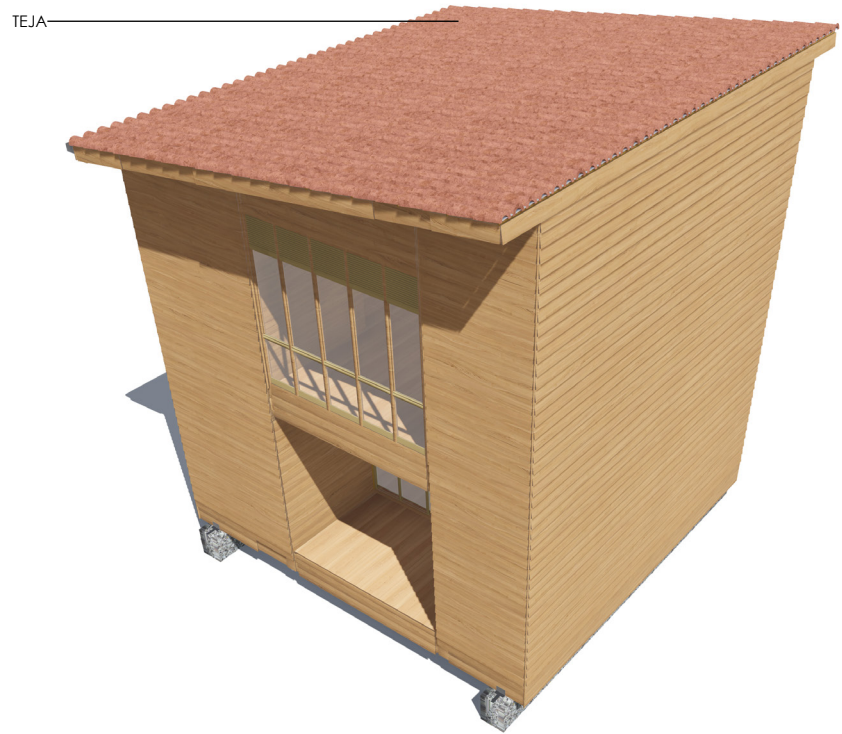
PERSPECTIVA COLOCACIÓN DE TEJA Y CARPINTERÍA
