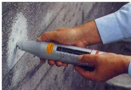
Foto 52. Esclerometría realizada a un elemento de hormigón. [Fotografía de civilgeeks.com]
