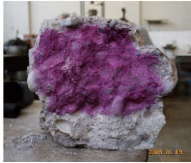
Foto 50. Variación de la fenolftaleína con el pH del hormigón. [Fotografía de Hugo Barrera].
