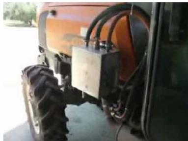
**Figura 2.8.-** Sistema Pantone (procesador GEET) acoplado al transporte terrestre
