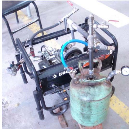
*Figura 3.17.- Sistema Pantone GEET B y tanque acoplado al MCI
