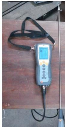
*Figura 3.1.- Analizador de Gases*
