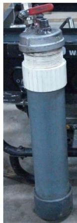
**Figura 3.14.- Burbujeador de 3 L de capacidad**
