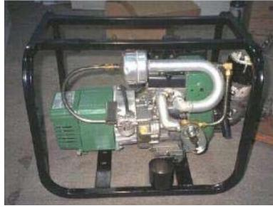
**Figura 2.7.-** Sistema Pantone (procesador GEET) acoplado a un generador eléctrico.
