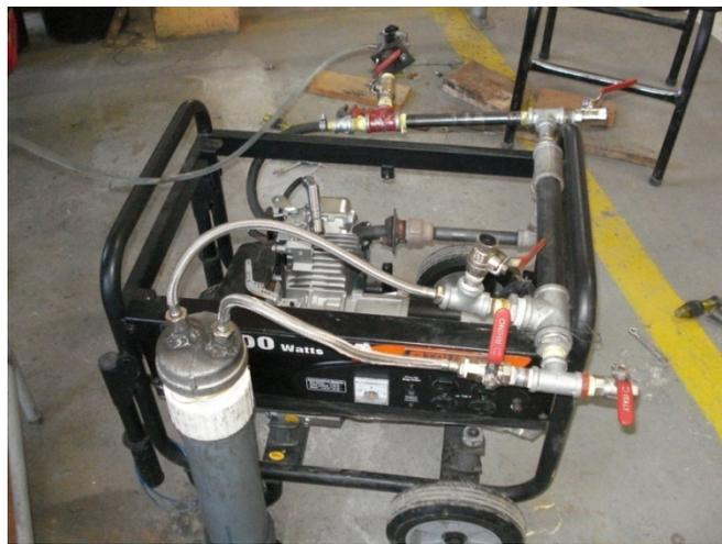
*Figura 3.15.- Sistema Pantone GEETA y burbujeador acoplado al MCI*
