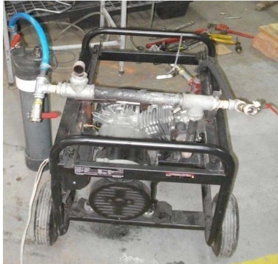
**Figura 3.16.- Sistema Pantone *GEET B* y burbujeador acoplado al MCI
