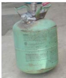
*Figura 3.11.- Tanque hermético de 10 l de capacidad*
