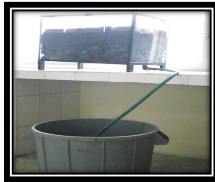
Fig. 4.8. Sistema de desaguado del lecho de secado
