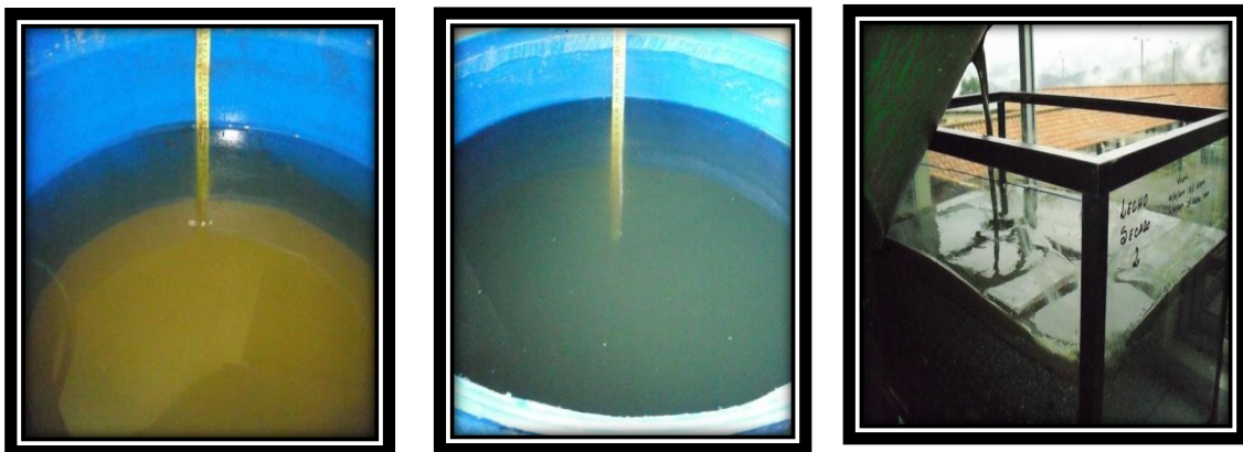
Fig. 5.1. Prueba para determinar el porcentaje de lodo concentrado en tanque de sedimentación
