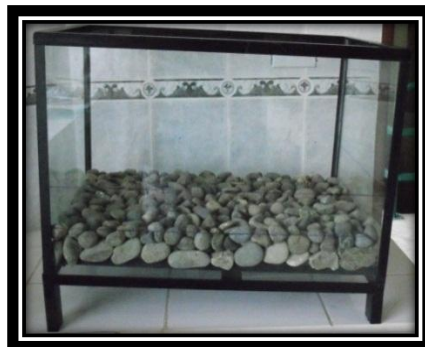
Fig. 4.9. Colocación de la capas de grava en el lecho de secado
