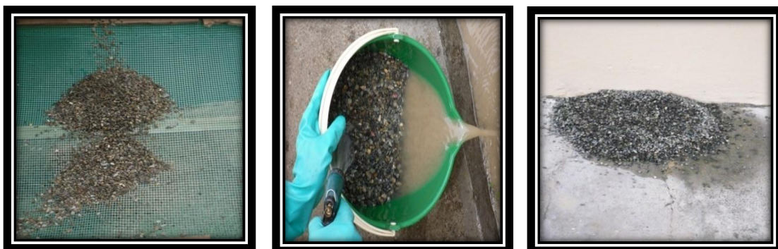
Fig. 4.4. Tamizado, lavado y secado de la gravilla
