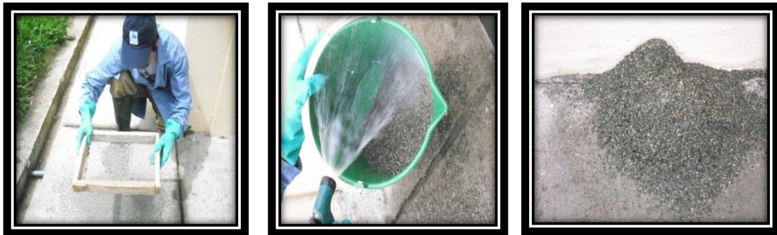
Fig. 4.5. Tamizado, lavado y secado de la arena
