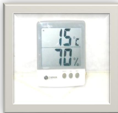
Fig. 4.14. Higrómetro utilizado para determinar la Humedad Relativa
