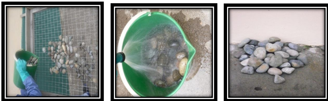
Fig. 4.3. Tamizado, lavado y secado de la grava
