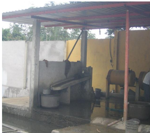
Fotografía No 3. Canalón de cemento, para concentración gravimétrica.
