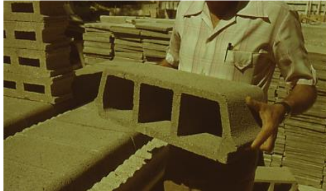
Figura 6: Bovedilla de Mortero, producida industrialmente, y montaje en las viguetas. Fuente: Ing. Nelson Navarro, Ph.D.
