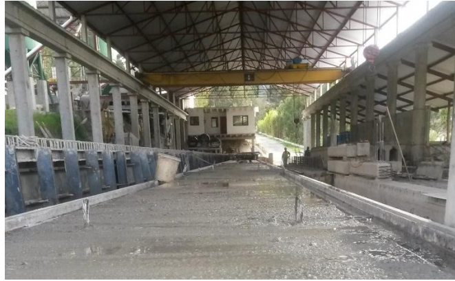
Figura 2: Fábrica RFV Carrasco Construcciones, dedicada a la elaboración de elementos de hormigón pretensado.
