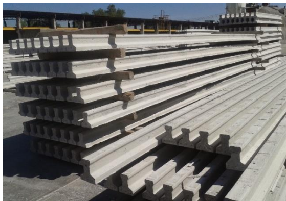
Figura 44: Forma correcta de almacenar las Vigas Prefabricadas-Pretensadas. Fuente: Blogspot Metal Bones.
