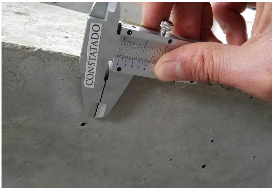
Fisura (carga de trabajo = 0,1 mm)
