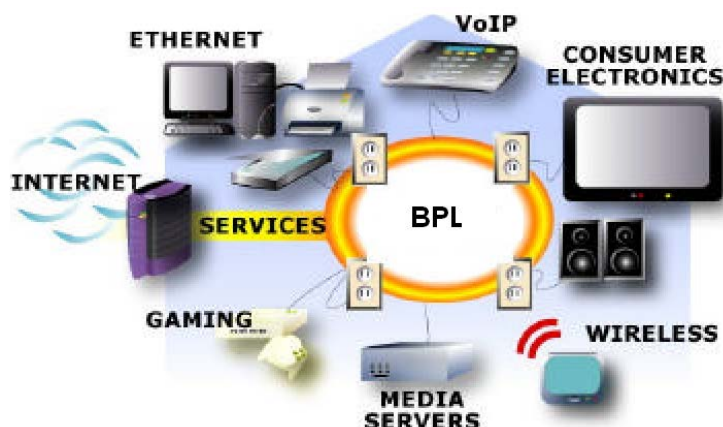
Figura 3.11. Sistema de Banda Ancha por la Red Eléctrica.
