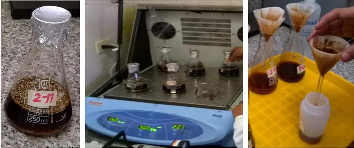
Figura 28 (a) Erlenmeyer con biomasa y agua a tratar (b) Muestras en equipo de agitación (c) Filtrado de muestras
