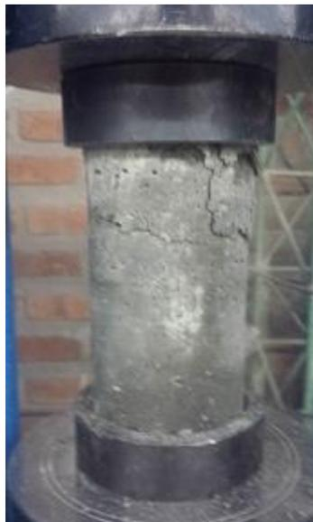
Foto G.9 Cilindro con Hormigón Celular realizando la prueba de compresión
