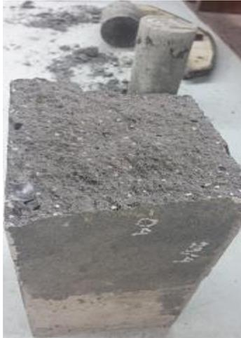
Foto G.10 Sección de viga fallada por carga a flexión
