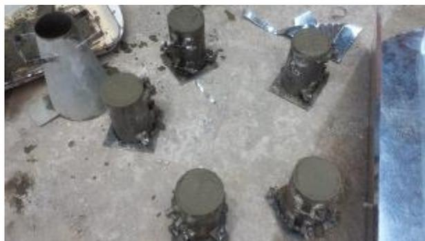
Foto G.6 Cilindros con el Hormigón Celular
