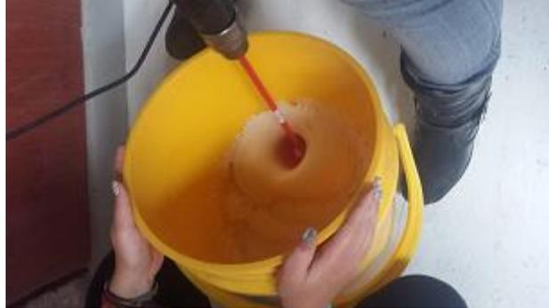
Foto.G.1 Elaboración de la espuma mediante batido mecánico
