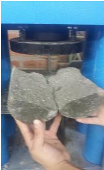
Foto G.11 Sección de cilindro fallada por tracción (compresión indirecta)
