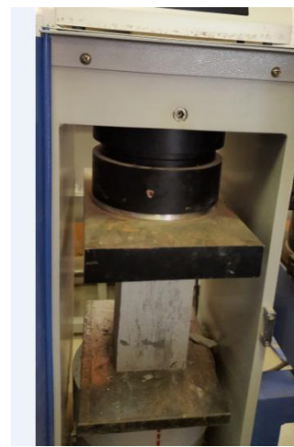
Foto. 5 Ensayos a flexión y compresión de las muestras escaladas tipo viga y columna respectivamente. (Tomado del anexo 5)
