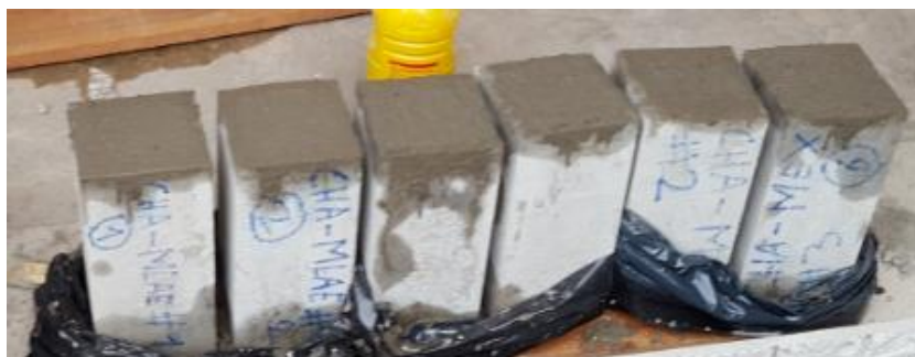
Foto. 3 Muestras de columnas a ser ensayadas (Tomado del anexo 4)
