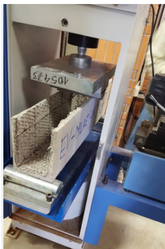
Foto. 5 Ensayos a flexión y compresión de las muestras escaladas tipo viga y columna respectivamente. (Tomado del anexo 5)
