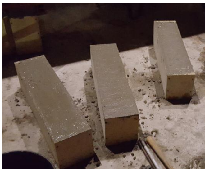
Foto. 4 Muestras de vigas de referencia a ser ensayadas (Tomado del anexo 4)
