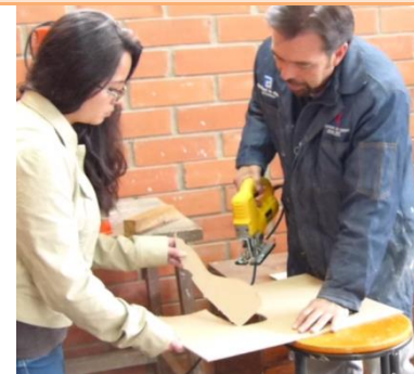
Imagen 29 Corte con caladora.
