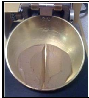
Foto 2.12 Gráfica del ensayo del límite líquido, cuchara de Casagrande
