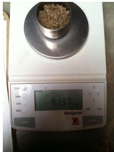
Foto 2.9 Peso de muestra de suelo húmedo
