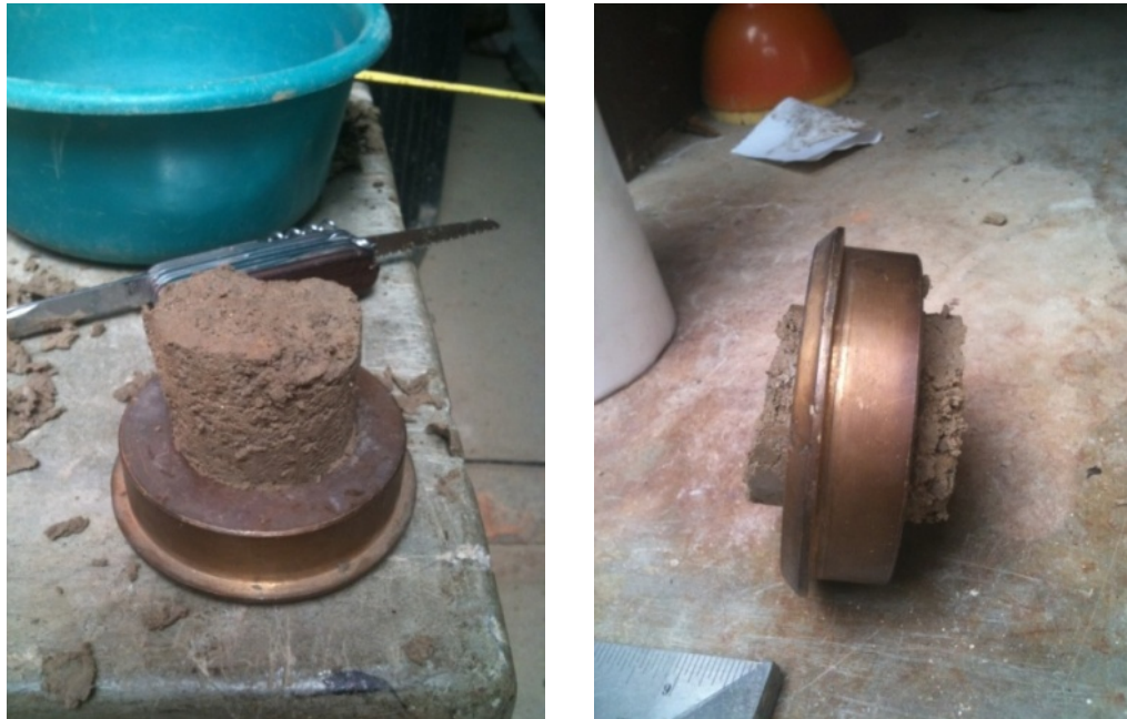
Fotos 3.4. Muestra # 7 perfilada para colocarla en el molde de 2"
