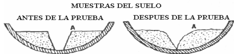
Foto 2.12 Gráfica del ensayo del límite líquido, cuchara de Casagrande
