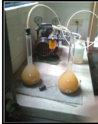
Foto 2.11 Gráfica de vacío aplicado a muestras para determinar G_s
