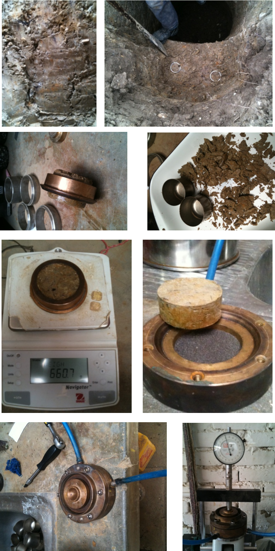
Fotos 3.2 Colocación de la muestra en el consolidómetro
