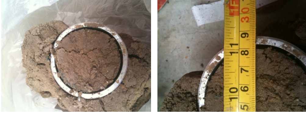
Fotos 3.3 Contracción muestra # 7 a los costados del anillo.
