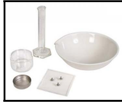
Foto 2.13 Gráfica del procedimiento para determinar el volumen de las pastillas con mercurio
