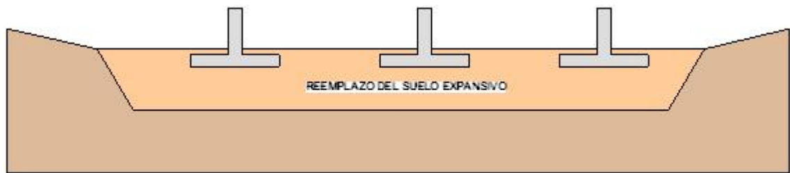
Figura 1.19 Reemplazo del material expansivo
