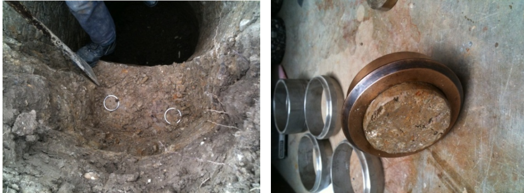
Fotos 2.6 Muestra inalterada para ensayo de expansión libre y presión de expansión
