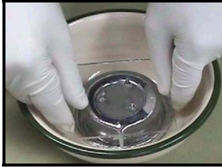
Foto 2.13 Gráfica del procedimiento para determinar el volumen de las pastillas con mercurio
