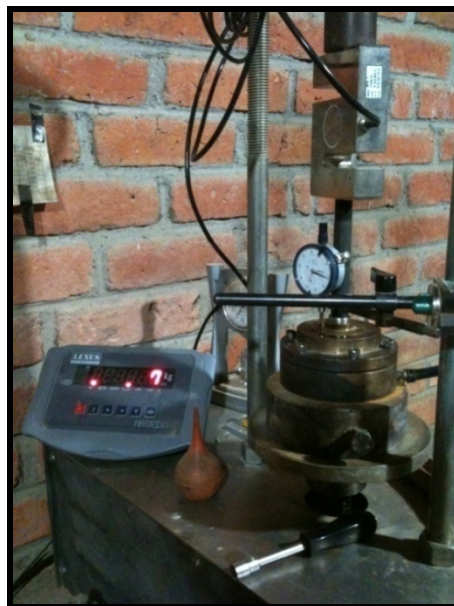
Foto 3.5. Montaje del consolidómetro en el equipo Marshall
