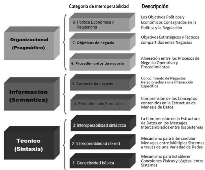
Figura 2.8. Capas de interoperabilidad según la GWAC. [18]
