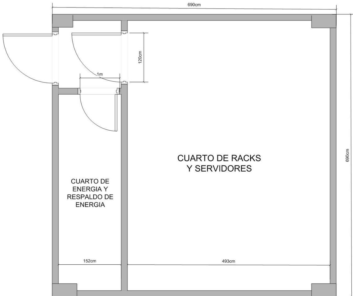
Fig. 4.5. Dimensiones sugeridas para la ubicación del Data Center de la UNL.
