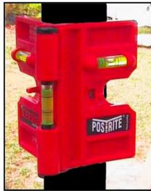
Figura: 5.1: Alineamiento de la base de la antena parabólica
