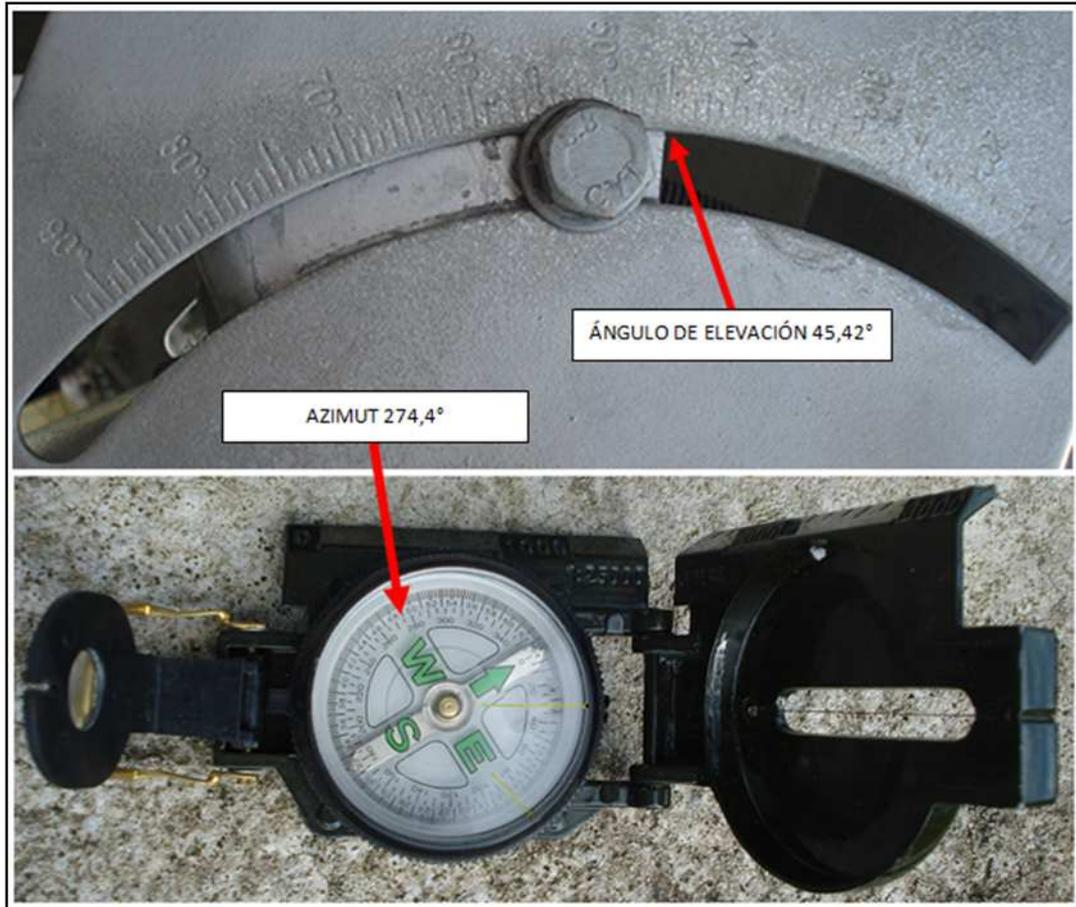
Figura: 5.7: Azimut y ángulo de elevación de la antena parabólica
