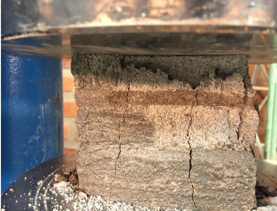
Foto N° 44 Ensayo de Muretes
