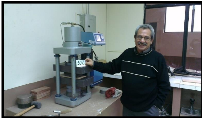
Foto N° 36 Compresión de ladrillos al 55%
