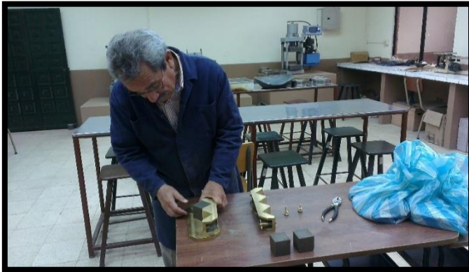
FotoNº16 Desencófrado de Probetas
