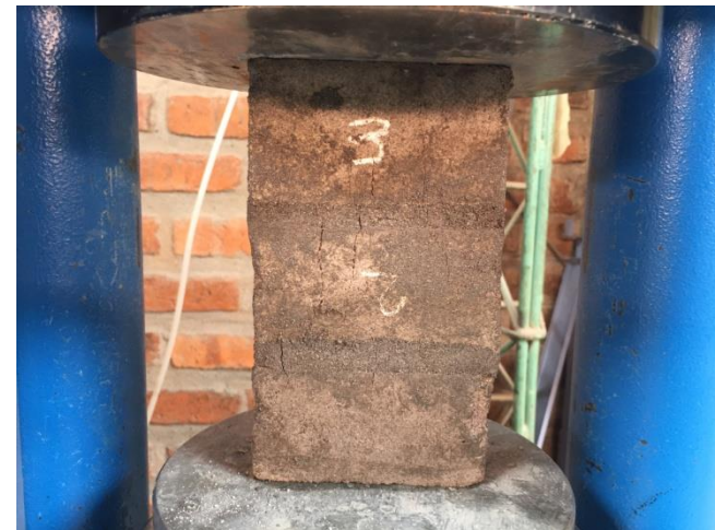
Foto N° 43 Ensayo de Muretes
