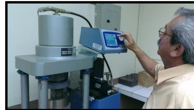
FotoNº20 Rotura de Probetas
