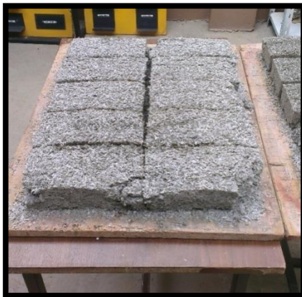
FotoN°28 Elaboración de ladrillo con 70 % de adición de PET
