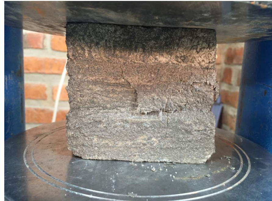
Foto N° 45 Ensayo de Muretes
