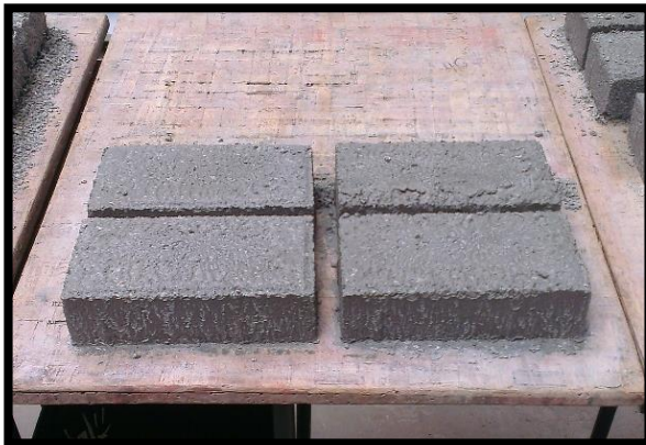
Foto N° 25 Elaboración de ladrillo con 40 % de adición de PET
