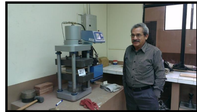
Foto N° 34 Compresión de ladrillos al 25%
