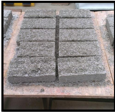
Foto N° 27 Elaboración de ladrillo con 65 % de adición de PET
