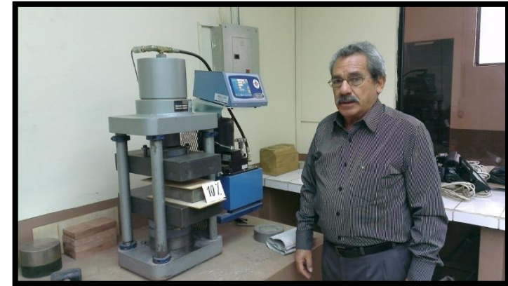
Foto N° 33 Compresión de ladrillos al 10%
