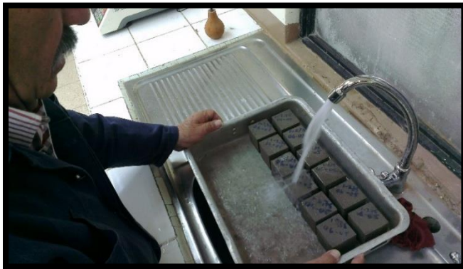
FotoNº 17 Curado de Probetas
