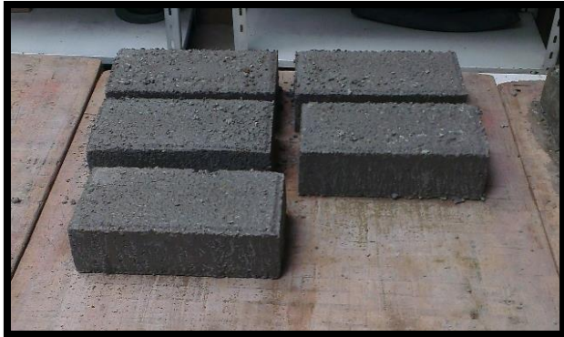
Foto N° 24 Elaboración de ladrillo con 25 % de adición de PET
